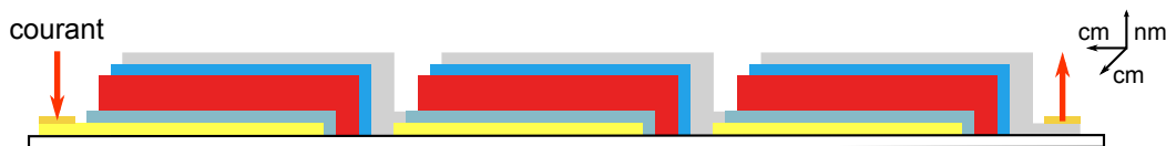
FIGURE 3.24 – Coupe latérale d'un module solaire composé de 3CSOs connectées en série. Les hauteurs ont été exagérées pour faciliter la lecture du schéma (latéralement on a des dimensions de l'ordre du cm tandis que verticalement on a des épaisseur de l'ordre du nm).
