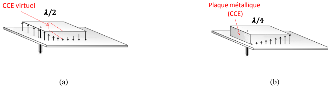
Figure I.37: Représentation du champ E pour les antennes patchs imprimées - (a) Antenne \lambda/2 , (b) Antenne \lambda/4
