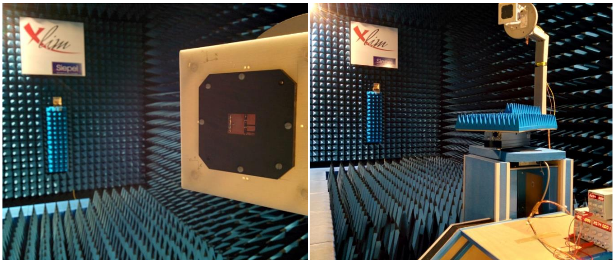
Figure III.19: Photographie du banc expérimental ayant permis la mesure de l'antenne
