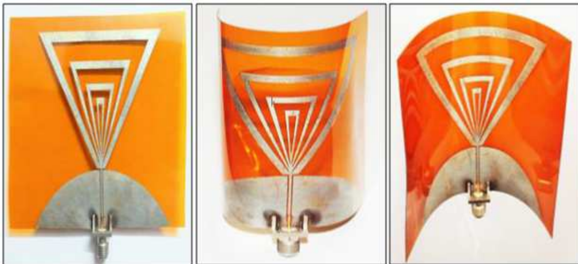
Figure II-3.- Antenne fabriquée par jet d'encre sur un substrat de Kapton en différentes configurations. Configuration planeaire (gauche), configuration convexe (centre), configuration concave (droite) [II.51].
