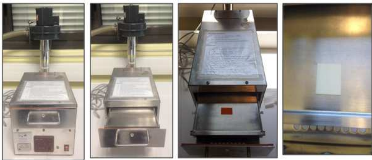
Figure II-30.- Machine où les substrats de kapton et alumine ont été soumis à un bain plasma ozone.
