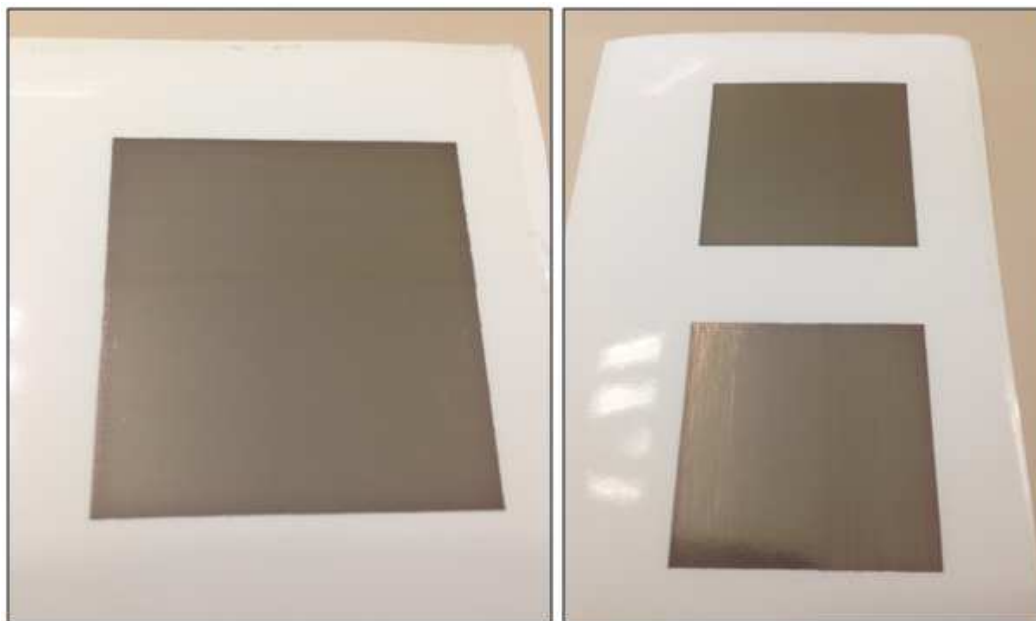
Figure III-15.- Motifs carrés imprimés avec notre encre d'argent pour les caractériser.
