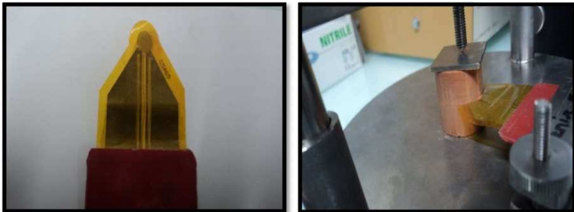
Figure II.16 : La sonde utilisée lors de la mesure de la conductivité thermique des échantillons.
