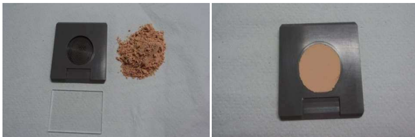
Figure II.9 : Préparation d'un échantillon d'argile pour la DRX.
