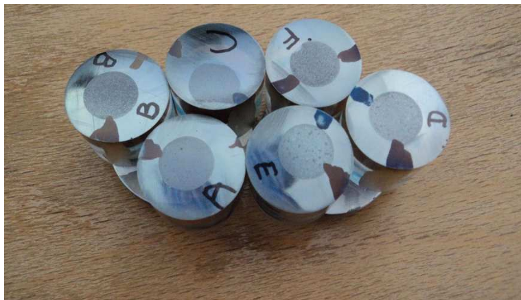
Figure II.15 : Échantillons imprégnés par la résine IP et métallisés.
