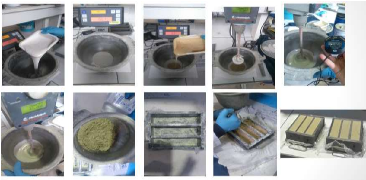
Figure III. 14 : Les différentes étapes de fabrication des mortiers de résine
