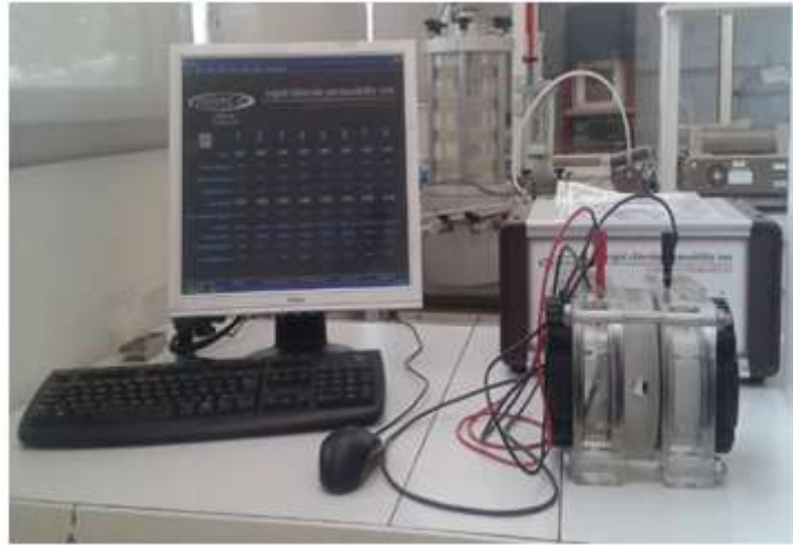
Figure II. 19 : Dispositif expérimental de la diffusion des ions chlorure
