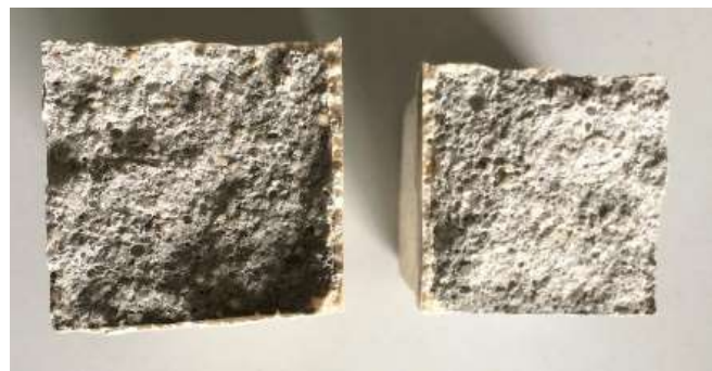
Rupture cohésive dans le support
