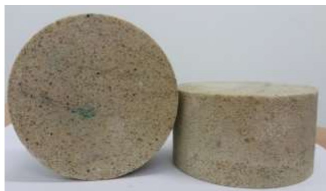
Figure II. 18 : Eprouvettes cylindriques utilisées pour l'essai de diffusion des ions chlorures
