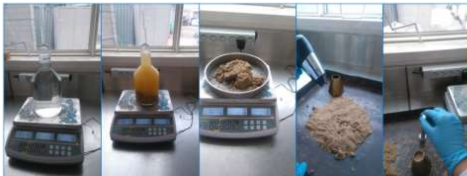
Figure II. 8 : Mesure de la masse volumique, de la porosité et de l'absorption WA_{24} du sable
