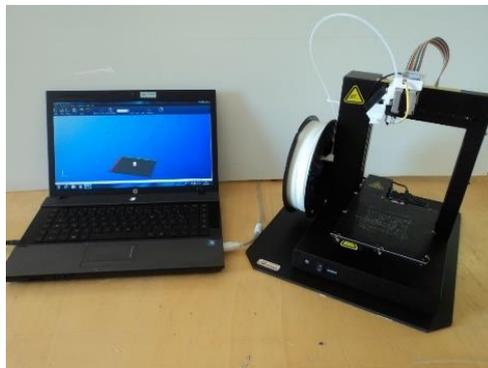
Figure 21 : poste de travail - système d'impression 3D
