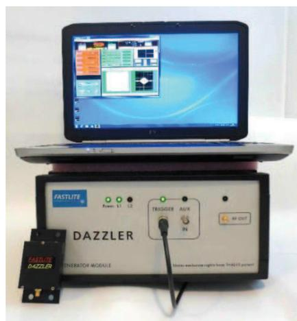
Figure 2.11 : Dazzler<sup>TM</sup> : modulateur acousto-optique programmable (AOPDF) qui permet une modulation en amplitude et en phase du spectre.
