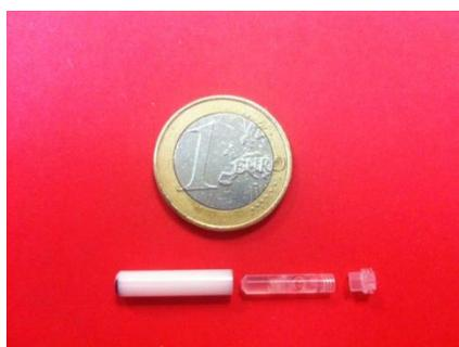
Figure 19 : Photographie du dispositif HR-MAS utilisé pour la préparation des différents échantillons étudiés à l'aide de cette technique. De gauche à droite sur la Figure : le rotor, l'insert jetable de 33  $\mu$ l et le capuchon (ailettes).
