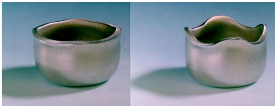
Figure I.A. 10 : formation des cornes après emboutissage à cause de l'anisotropie de la pièce.
