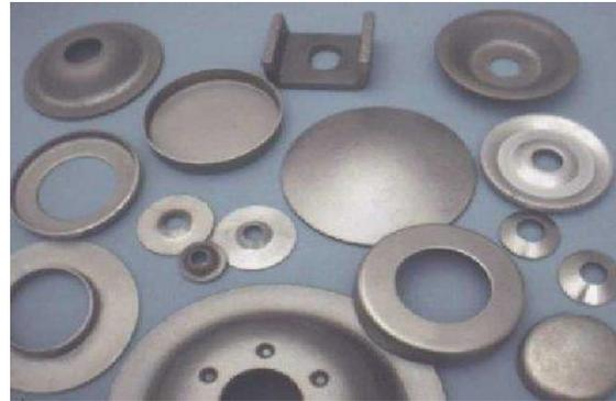
Figure I.A. 8.b : différentes applications de l'emboutissage.
