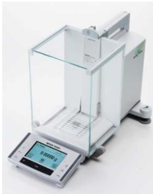
Figure II-11. Balance électronique METTLER TOLEDO (Modèle XS 204).
