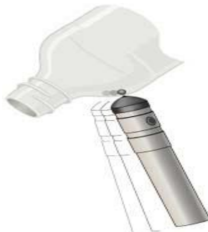
Figure II-5. Sonde à effet Hall pour la mesure d'épaisseur des flacons.
