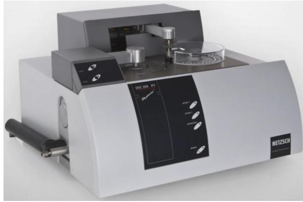
Figure II-15. Calorimétrie différentielle à balayage NETZSCH – DSC 204 F1 Phoenix.
