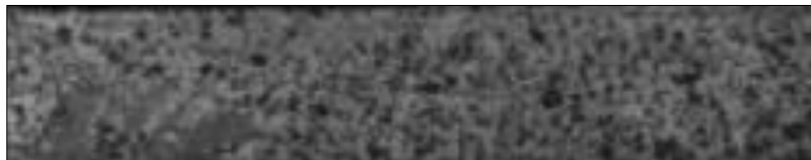
Figure II-17. Image d'un mouchetis obtenu sur une éprouvette de traction.
