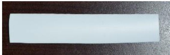
Figure II-7. Photo des éprouvettes utilisée pour le vieillissement.
