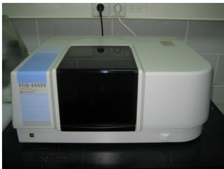
Figure II-13. Image du spectromètre infrarouge SHIMADZU 8400S.
