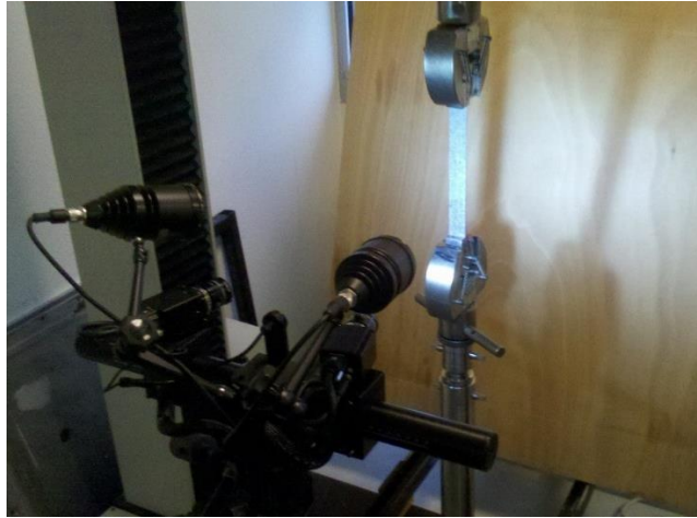
Figure II-16. Montage de l'essai de traction de type Instron 33R 4204 couplé au système de mesure de déformation ARAMIS.
