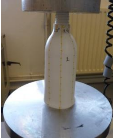
Figure II-20. Photo du montage en compression.
