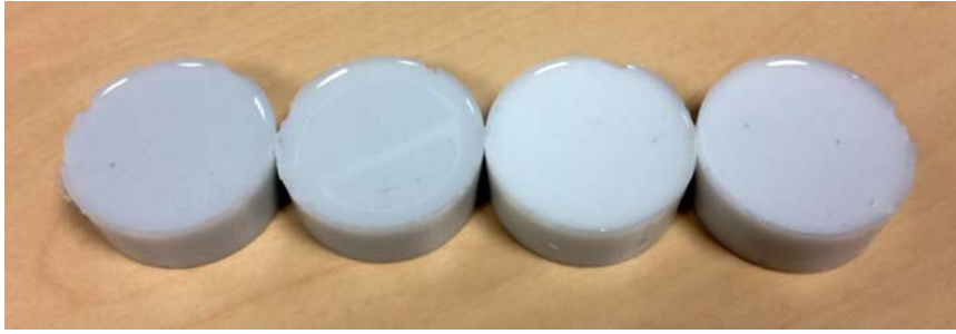
Figure 2-19 : Gamme de fantômes à \mu'_{s2} avec, de gauche à droite, \mu_a décroissant
