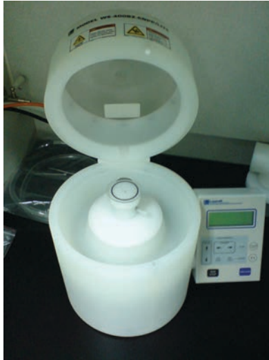
Figure 2-14 : Tournette ou spin coater servant au dépôt d'une couche de PDMS d'épaisseur contrôlée
