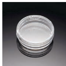
Figure 2-9 : Boîte de culture cellulaire (FALCON) utilisée pour mouler les dermes des fantômes multicouches
