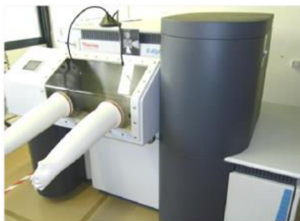
Figure II-20 : Spectromètre XPS K-alpha Thermo Scientific et sa boîte à gants connectée
