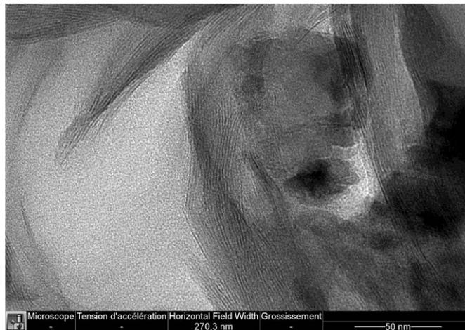
**Figure I.31.** Micrographie MET de la bentonite.
