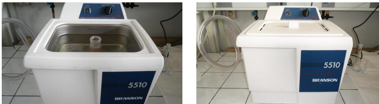
Figure II.5. Appareil Ultrason (BRANSON 5510).
