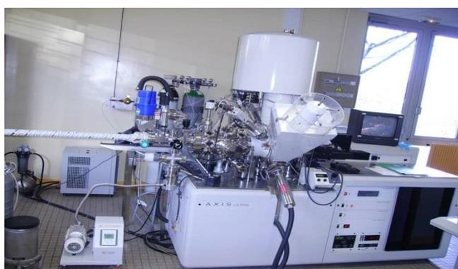
**Figure I.11.** Spectroscopie de photoélectrons X (XPS) (KRATOS AXIS ULTRA)
