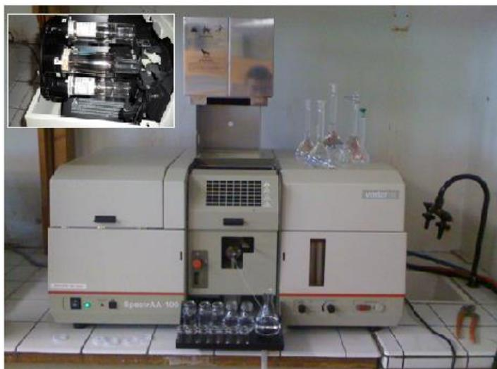
**Figure IV.3.** Spectroscopie d'absorption Atomique SpectrAA-100 VARIAN
