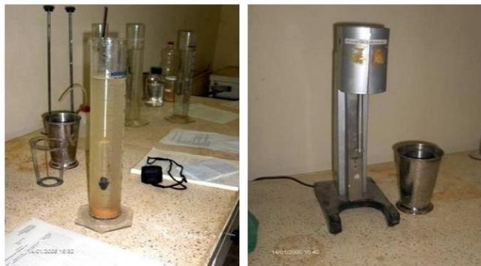
**Figure I.17.** Analyse granulométrique par sédimentométrie.
