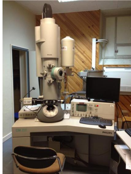
**Figure I.13.** Microscopie électronique en transmission (MET)
