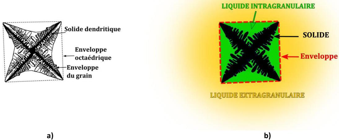
Figure II.2-3 : Schéma d'un grain équiaxe en 2D. a) : Notion d'enveloppe, reliant les pointes des bras primaires et secondaires et comparaison avec l'enveloppe octaédrique utilisée dans SOLID. b) : Illustration des phases solide (en noir), liquide intragranulaire (en vert) et liquide extragranulaire (en jaune-orangé).
