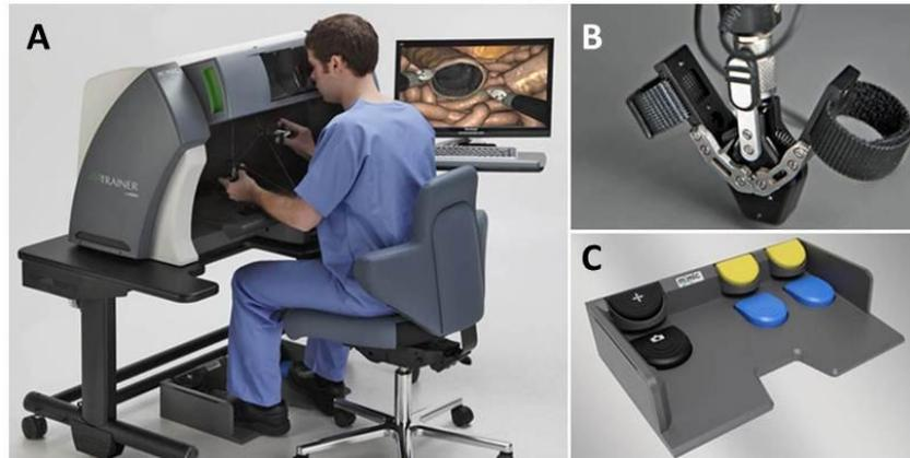
**Fig. 10** Le simulateur robotique dV-Trainer<sup>®</sup> : la vue d'ensemble (A), la manette (B) et le pédalier (C)
