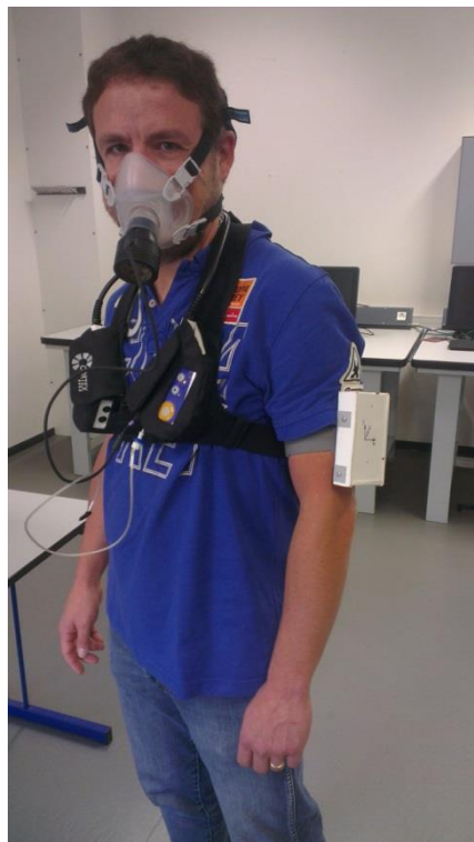
Figure 59 : Essai Metamax3B® /Dispositif à étalonner
