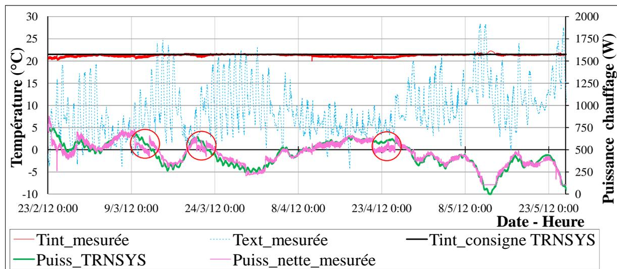
Figure VI-22 : Puissances lors de séquences d'humidification adiabatique : comparaison entre une modélisation TRNSYS et mesure
