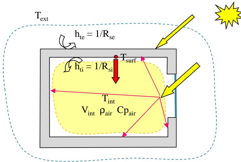
Figure III-8 : Bilan thermique de l'ambiance intérieure
