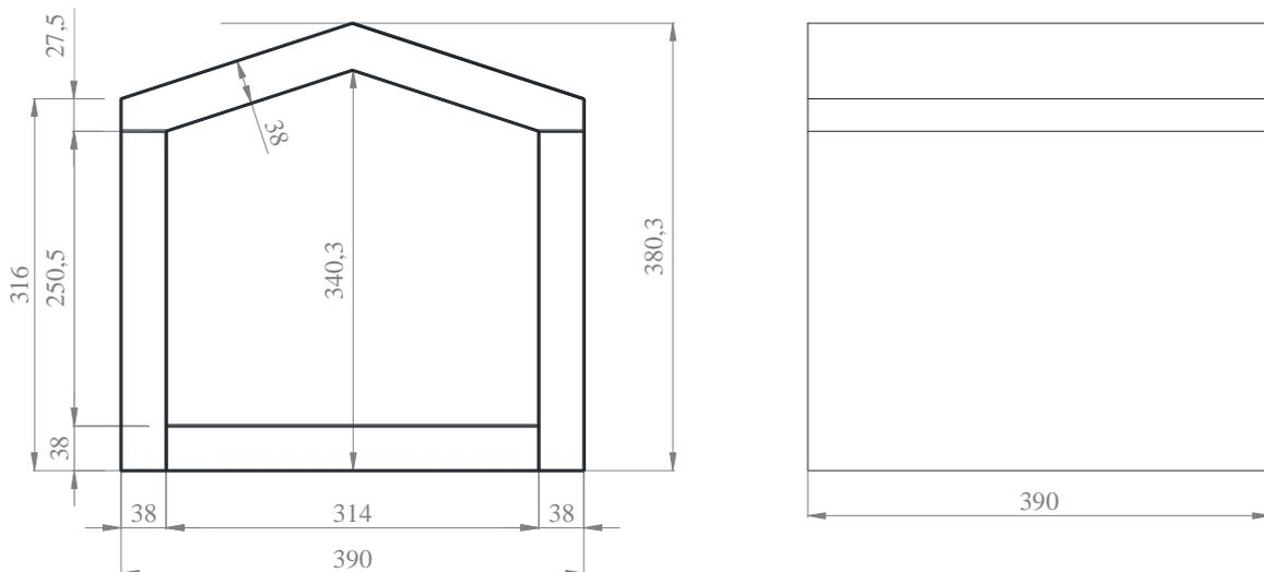
Figure VI-2 : Dimensions de la cellule-test béton de bois
