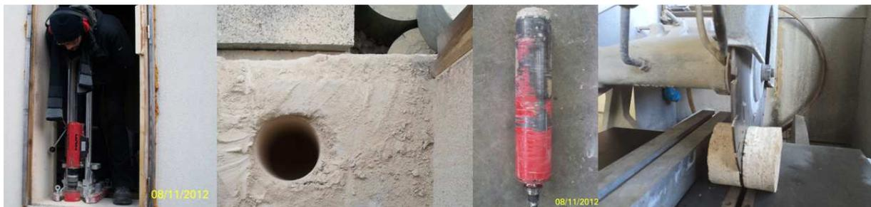
Figure IV-1 : Carottage et découpage des éprouvettes du béton de bois
