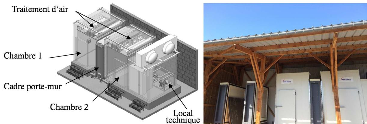
Figure V-1 : Enceinte bi-climatique : volume schématique et vue de face
