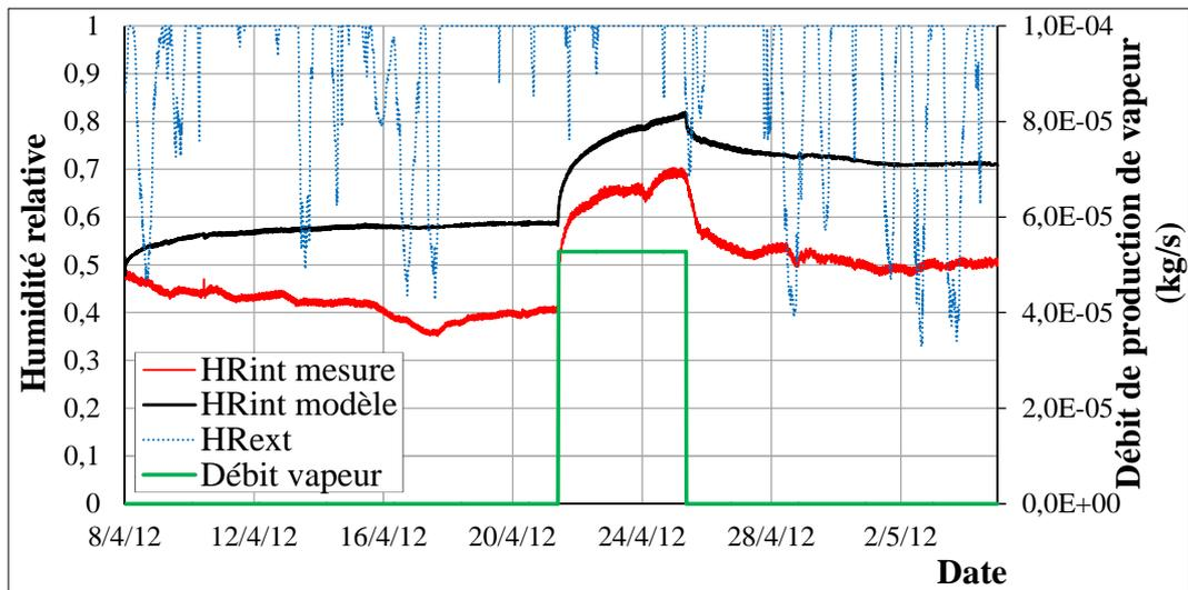
Figure VI-20 : Humidités relatives lors d'une séquence d'humidification adiabatique
