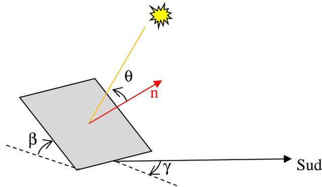
Figure III-6 : Flux solaire reçu par une surface inclinée
