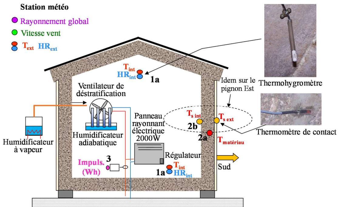
Figure VI-4 : Appareillage de la cellule-test béton de bois
