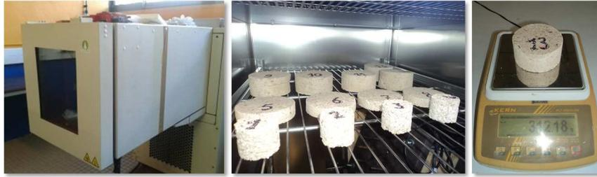
Figure IV-3 : Enceinte climatique et pesée des échantillons
