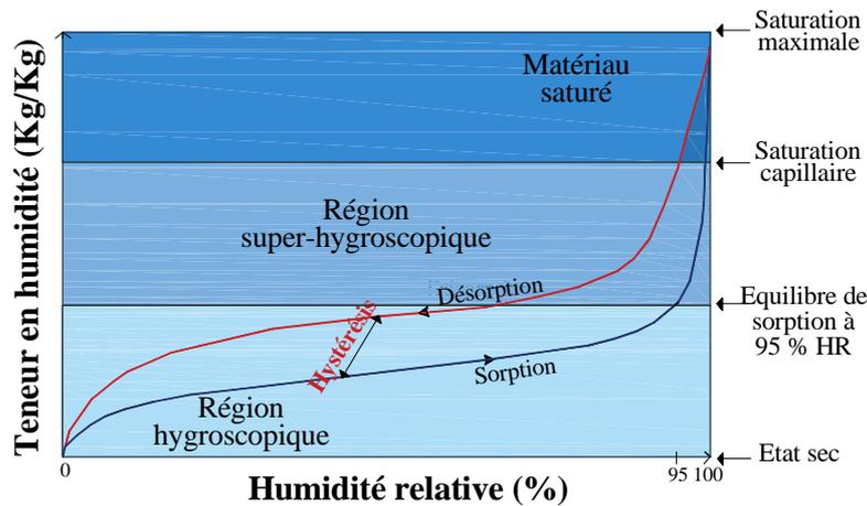
Figure I-11 : Allure générale d'une isotherme de sorption/désorption
