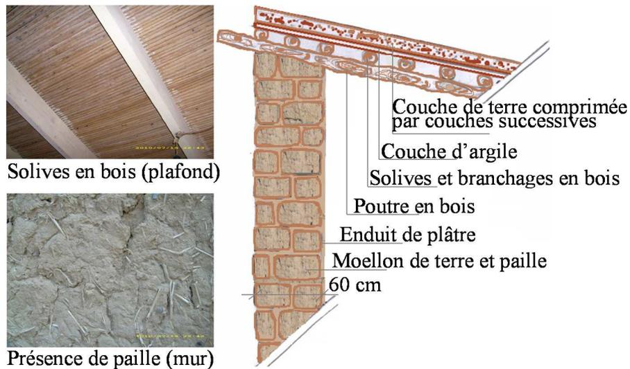
Figure II-13 : Détails de toiture et paroi externe
