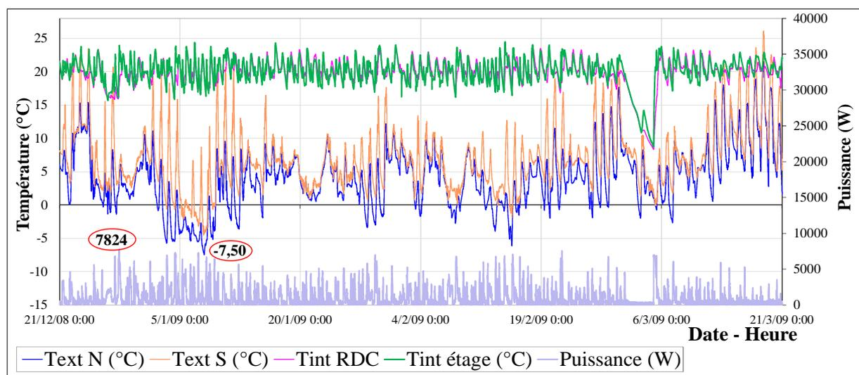
Figure II-65 : Variation horaire des températures intérieures/extérieures et la puissance électrique consommée, saison d'hiver « maison à ossature bois »
