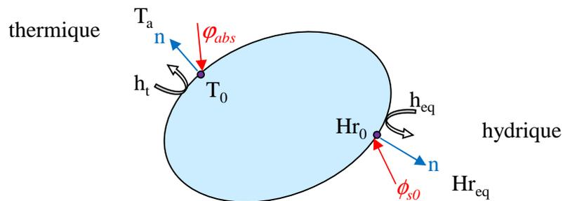
Figure III-7 : Echange superficiel
