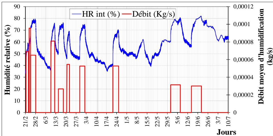
Figure VI-19 : Séquences d'humidification par évaporation d'eau
