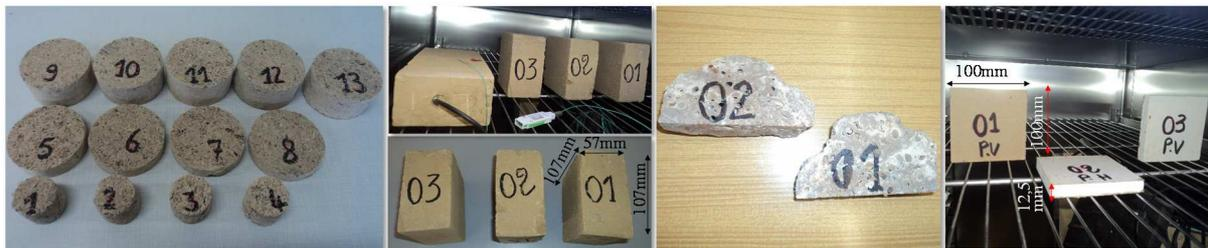
Figure IV-2 : Echantillons des matériaux béton de bois, terre crue, travertin et plaque de plâtre
