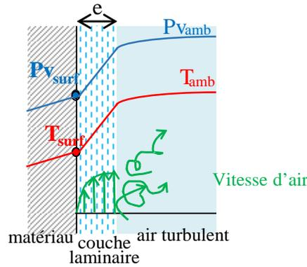
Figure III-5 : Echanges convectifs thermique et hydrique
