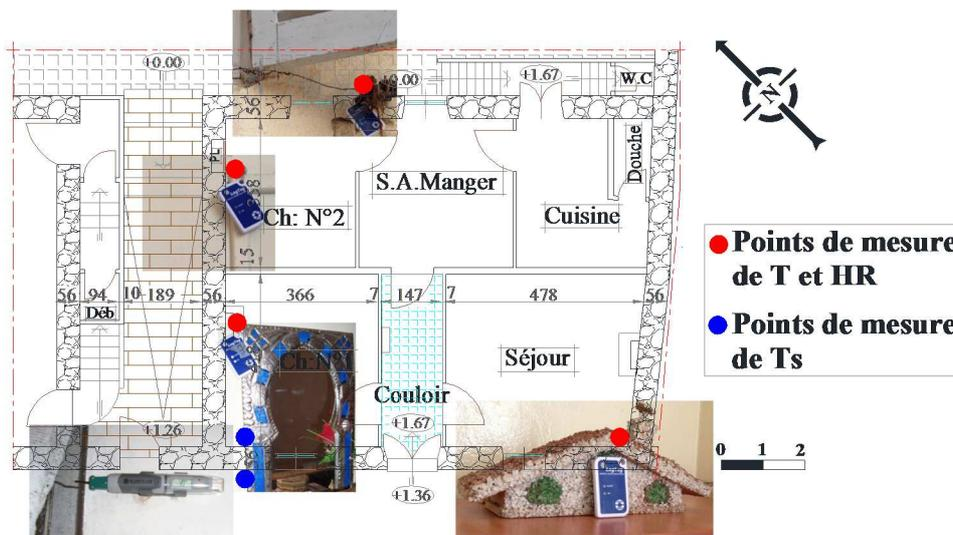
Figure II-39 : Plan de Rez-De-Chaussée et points de mesure (Maison en pierre)
