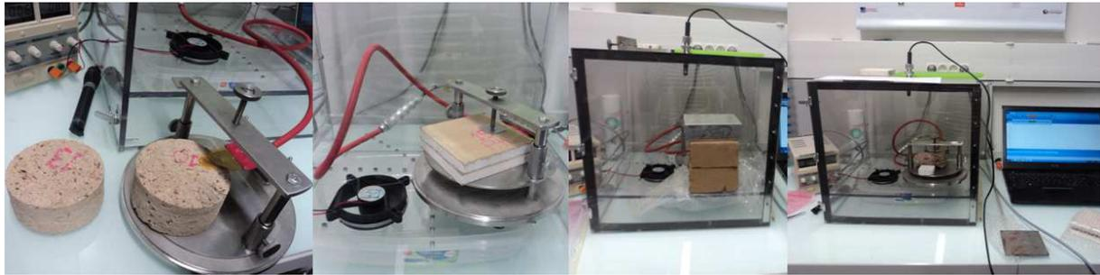
Figure IV-18 : Mesure de la conductivité thermique des différents matériaux par la méthode du disque chaud : béton de bois, plâtre, terre comprimée et le travertin
