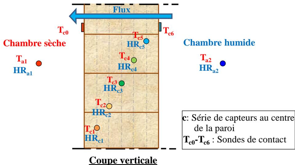
Figure V-4 : Nomenclature des capteurs de mesure
