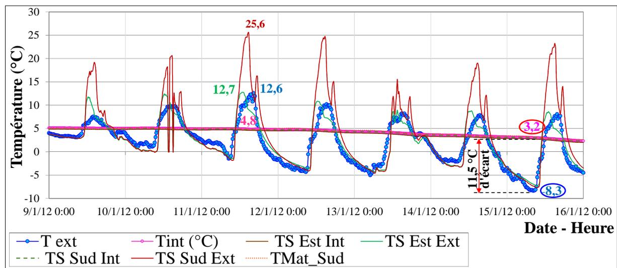
Figure VI-7 : Variation de la température intérieure, extérieure, surfacique et dans le matériau « béton de bois, semaine d'hiver »
