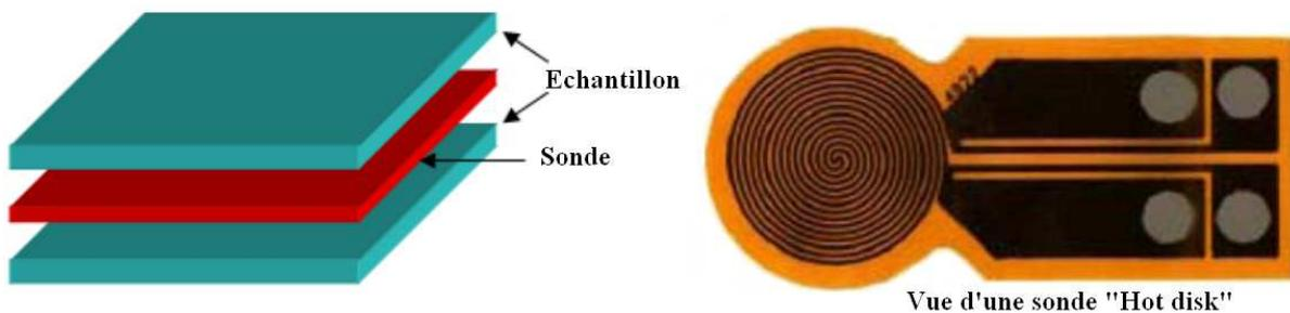
Figure IV-19 : Principe de la méthode du disque chaud
