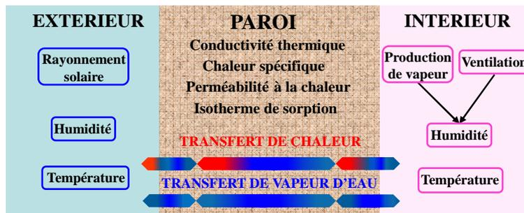
Figure I-9 : Transfert de chaleur et de masse à travers la paroi hygroscopique
