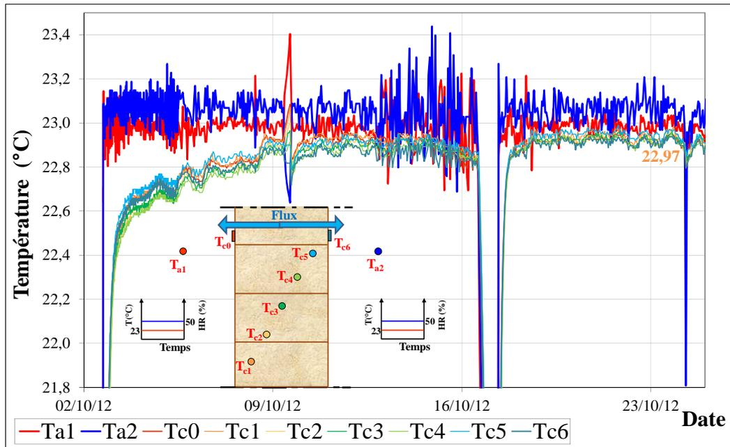
Figure V-8 : Distribution de température dans la paroi
