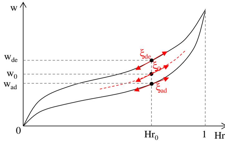
Figure I-12 : Construction d'une courbe isotherme partielle
