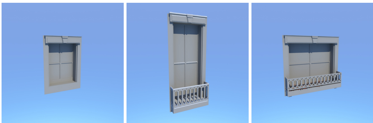
FIGURE A.1 – L'objet environnemental paramétré fenêtre s'adapte à différentes contraintes de dimension.
