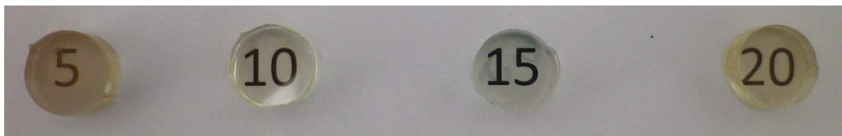
Figure III-19 : Photographies de verres dopés à hauteur de 0,075 wt% d'Or ayant été réalisés avec différents temps de fusion (en minutes), à 900°C
