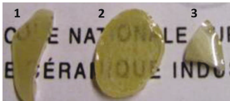
Figure III-44 : Photos de poudres de verre non « nettoyées » ayant subi un traitement de fluage à 430°C-30minutes. (1) : 80 < \emptyset < 250 \mu\text{m} ; (2) : 250 < \emptyset < 500 \mu\text{m} ; (3) \emptyset < 80 \mu\text{m}
