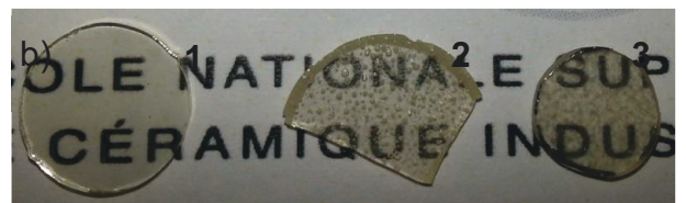
Figure III-45 : Spectres de transmission optique du verre de base, du verre pré-frittée et du verre fritté par SPS (a) et photographies (b) du verre de base (1), de la poudre de verre pré-frittée (2) et du verre fritté par SPS (3)
