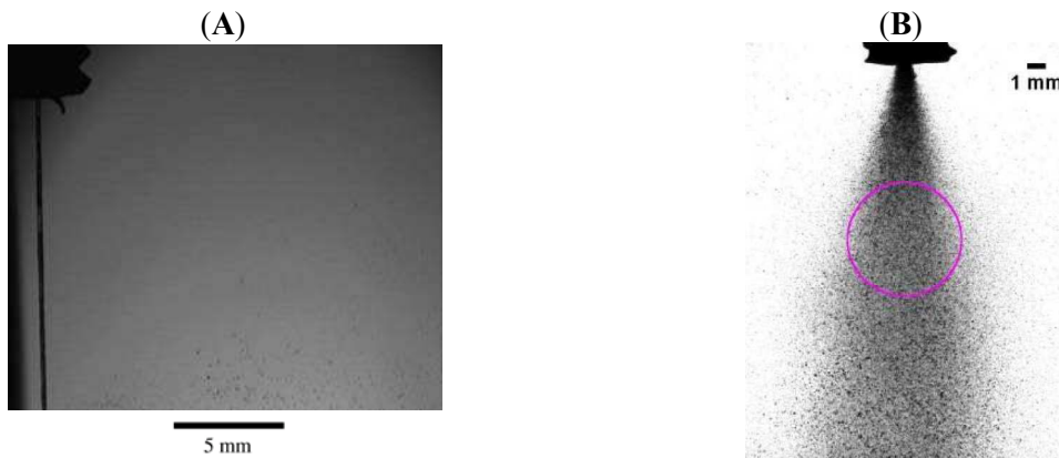
Figure 10 : Superposition d'images obtenues par ombroscopie laser pour les configurations (A) d'injection mécanique et (B) d'atomisation [57]
