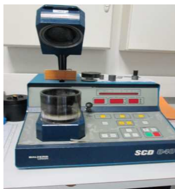
Figure II.8: Métalliseur SC D040
