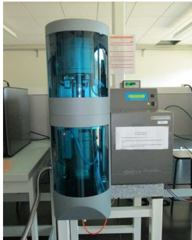
Figure II.10 : Dispositif de mesure ATD/ATG
