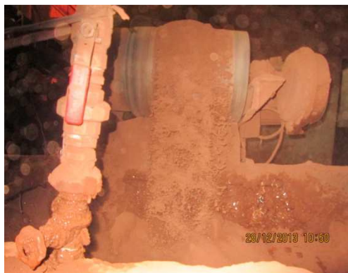
1.(a) : Mouilleur de la poudre naturelle (briquerie Médnine)
