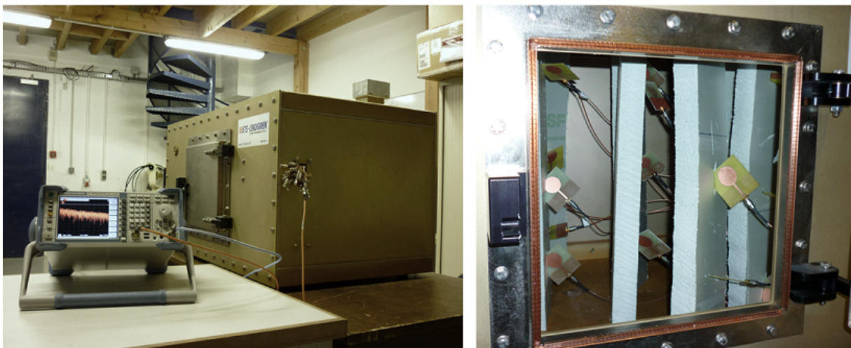
FIGURE 4.9 – Mesure des canaux du composant compressif volumique. Des sondes sont aléatoirement réparties dans la cavité, déterminant ainsi les couplages des canaux à chaque mode.
