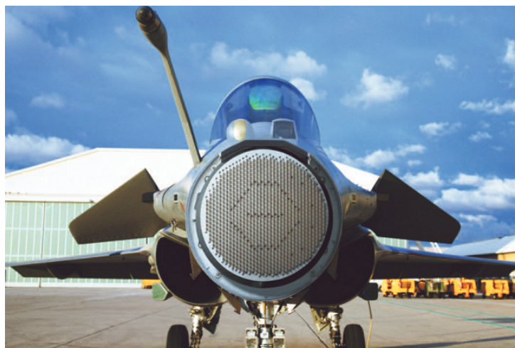
FIGURE 1.13 – Radar à balayage électronique actif RBE2-AESA de Thalès monté dans le nez d’un avion de chasse Rafale. [15]
