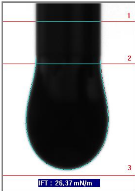
Figure 2.1.3 : Mesure de tension de surface de l'encre 1
