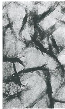
Figure 1.7.1.1 Cliché MEB des nanofilaments d'Alumine[70]
