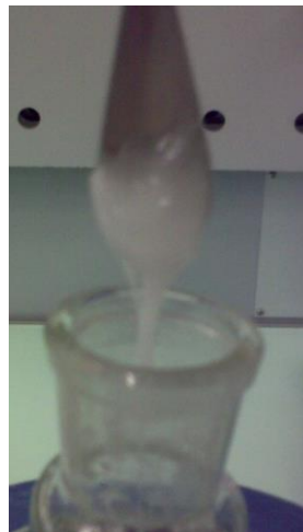
Figure 2.5.5.1. Observation de la gélification lors du greffage.
