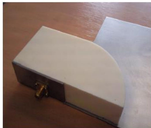
Figure II. 26 : Prototype réalisé de l'antenne, Réf. [78]
