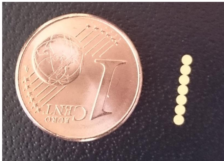
Figure III.48. Filtre de canal métallisé (cuivre+or) d'épaisseur 250 \mu m.
