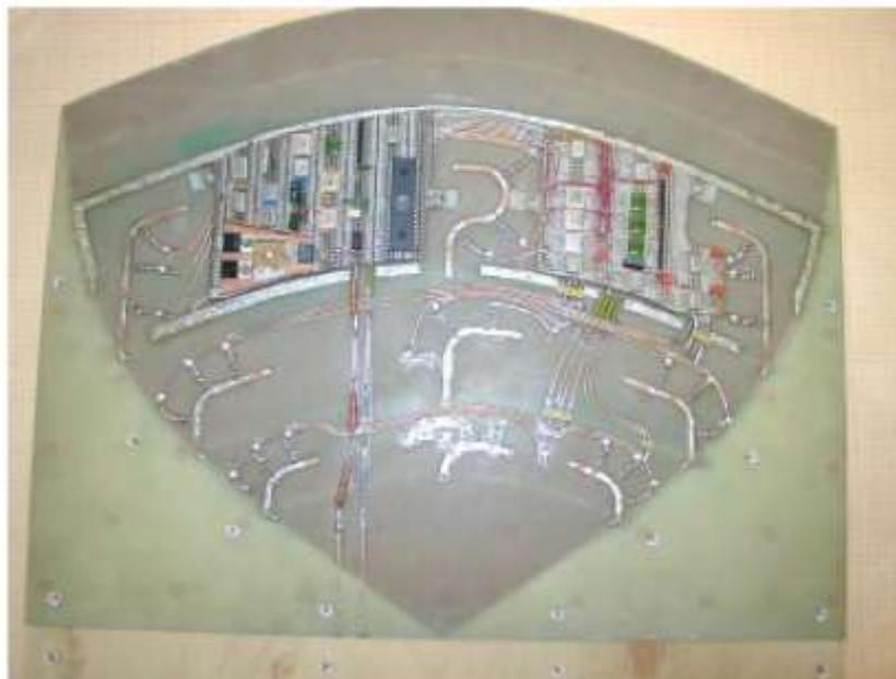
Figure 33 : Exemple d'une antenne Bow-tie commandée par des diodes PIN [51].
