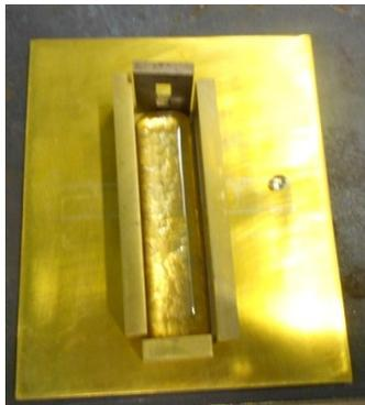
*Figure II- 5. Barreau de verre dans son moule placé sur une plaque en laiton.*
