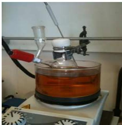
Figure 3: Photographie du montage des réactions de polymérisation
