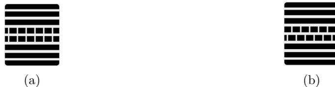
FIGURE 1.21 – Déphasage des sculpture pour limiter le sirènement [27] : (a) sans déphasage, (b) avec un déphasage de  $45^\circ$
