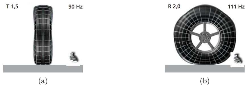
FIGURE 1.18 – Exemples de modes d'un pneumatique [27] : (a) Mode transversal (1,5), (b) Mode radial (2,0)
