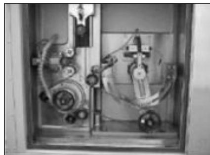
FIGURE 1.26 – Dispositif permettant d'étudier le bruit de courroie [35]
