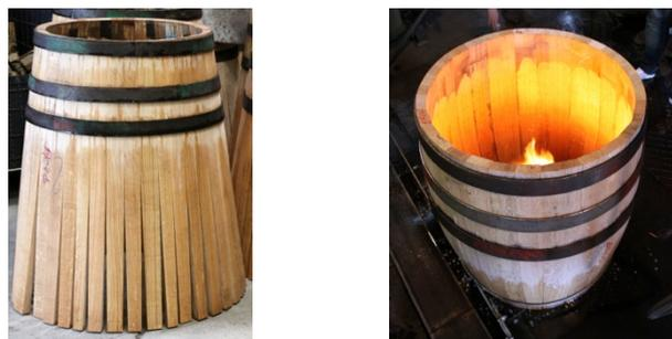
*Figure 7 : A gauche les douelles sont mises en rose et cerclées ; à droite chauffe et serrage d'un tonneau à l'aide d'un câble d'acier se resserrant progressivement en bas. (Olivier Colas CC BY-SA 3.0 via Wikimedia Commons)*
