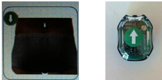
Figure 4.3. Vue supérieure du capteur vert et de son positionnement sur L5.
