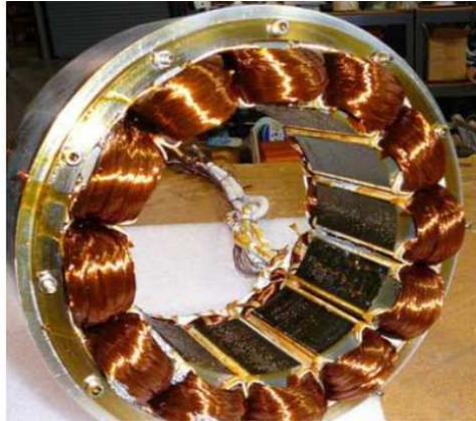
Figure 1.6 : Exemple d'un bobinage sur plot [83]
