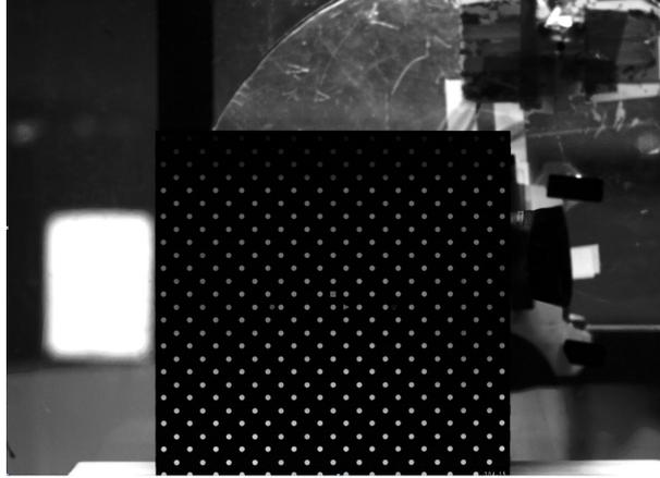
FIGURE 2.31. – Photogramme de la mire 3D dans la veine d'essai.
