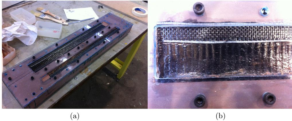
FIGURE 2.18. – Méthode de moulage par stratification par voie humide : a) vue générale, b) détail des plis de fibres de carbone au saumon du profil amont.
