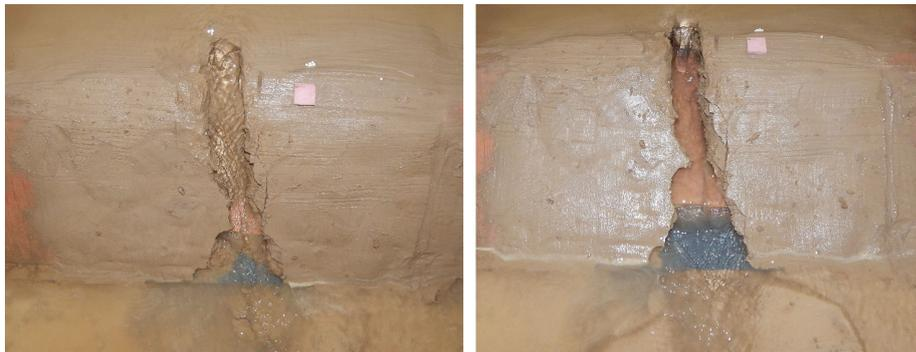
**Figure 137** – L'érosion du corps de digue débute en pied, côté ZP, et remonte rapidement vers la crête (photos prises à  $t_s = 38$  min et  $t_s = 41$  min).
