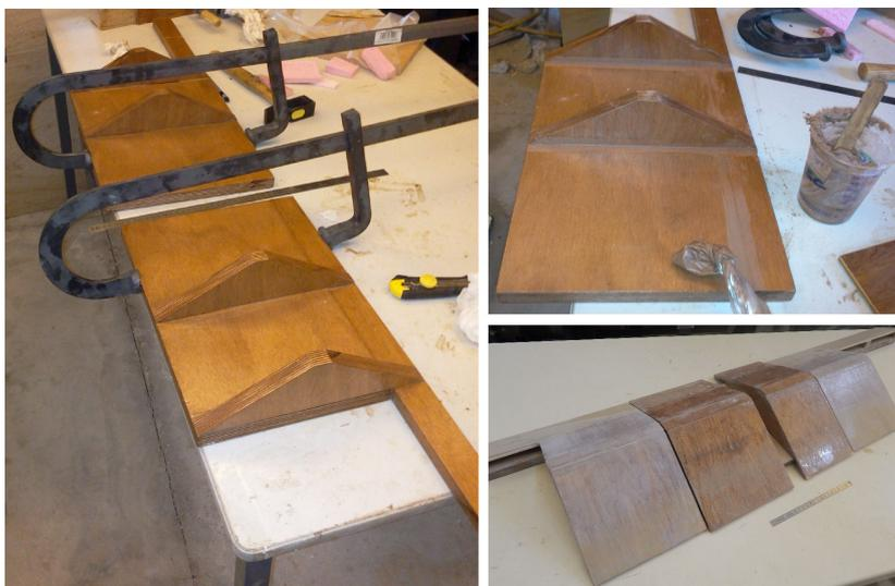
**Figure 59** – Etapes de construction des modèles réduits en bois. L'ensemble a très bien résisté à l'eau, notamment le module principal qui y a cumulé plusieurs mois.
