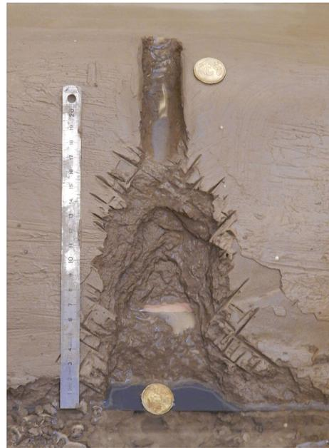
Figure 147 – Allure du chenal d'érosion à  $t_s = 16 \text{ h}$ . Alors que l'érosion adopte une forme plus diffuse sur le parement côté ZP, l'entrée de la brèche n'a pas évolué.
