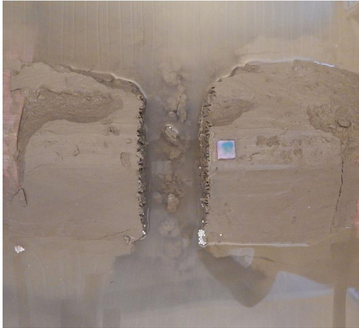
**Figure 126** – Ouverture de la brèche jusqu'à  $L_{\text{brèche}} = 80 \text{ m}$  à  $t_s = 45 \text{ h}$ . On a laissé les débris se déposer sur le fond du chenal d'érosion avant de reprendre l'essai.
