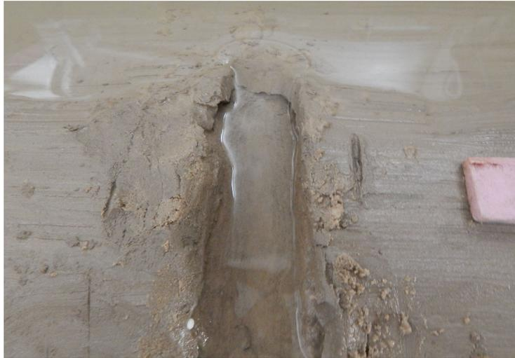
**Figure 135** – Détail de l'entrée de la brèche à  $t_s = 25$  min. Le sol s'est tassé sous l'effet de la saturation et se détache de la couche d'argile pure.
