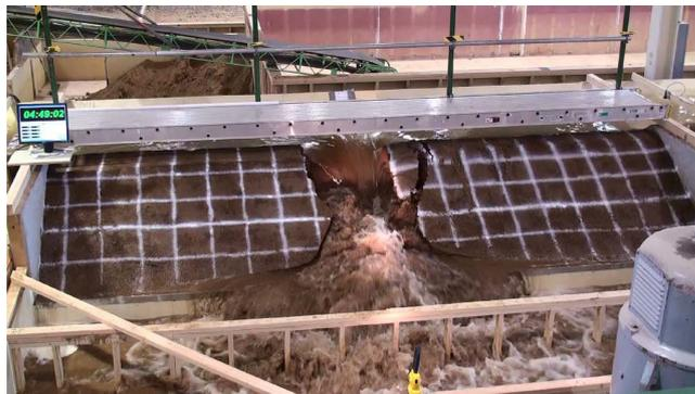
Figure 35 – L'arche au-dessus du renard s'effondre et un élargissement rapide débute, se produisant par effondrements successifs des parois de la brèche (Wahl et al., 2011).
