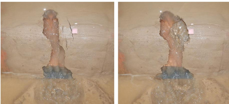
**Figure 139** – Des fissures apparaissent à l'amont de la brèche à  $t_s = 47$  min puis s'amplifient, jusqu'à ce qu'un bloc de plus de 50 mm de long ne s'effondre, le tout en moins d'une minute.
