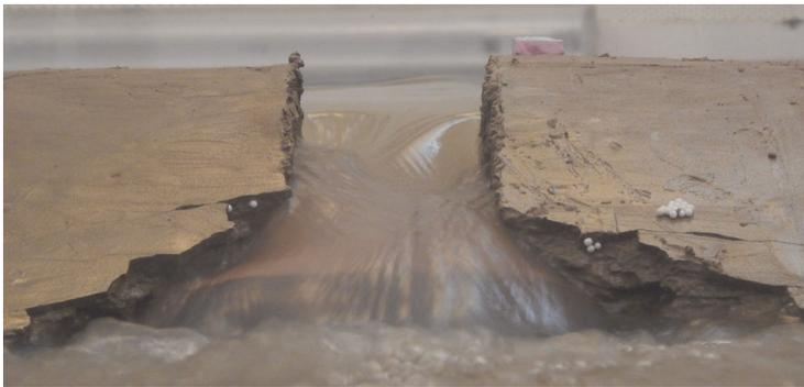
Figure 128 – Ligne d'eau le long de la brèche pour  $Q_A \simeq 40 \text{ m}^3/\text{h}$ . On obtient une ligne d'eau presque symétrique, avec un débit sortant orienté dans le sens du courant. Le risque de surverse généralisée à l'aval est en tout cas écarté à ce débit.
