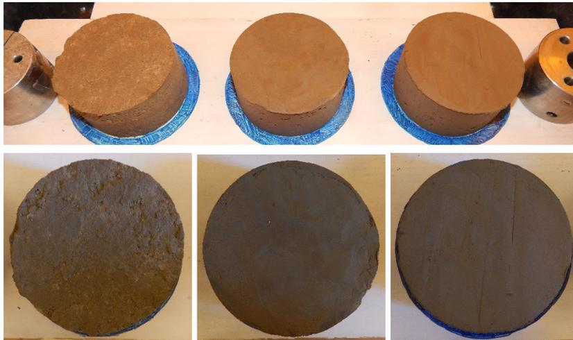
Figure 93 – Aspect initial des échantillons à 50 % d'argile ( $w=11, 14$  et  $17$  %, de gauche à droite).
