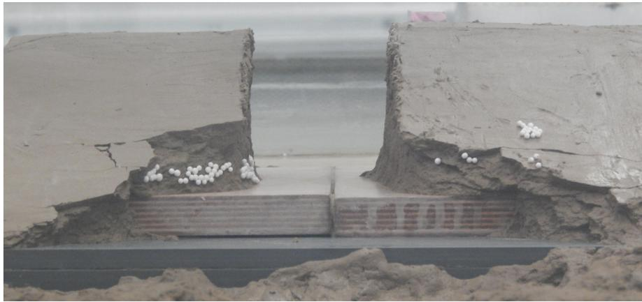
**Figure 130** – Le parement côté ZP est en bon état à la fin de l'essai, et les parois de la brèche sont restées verticales
