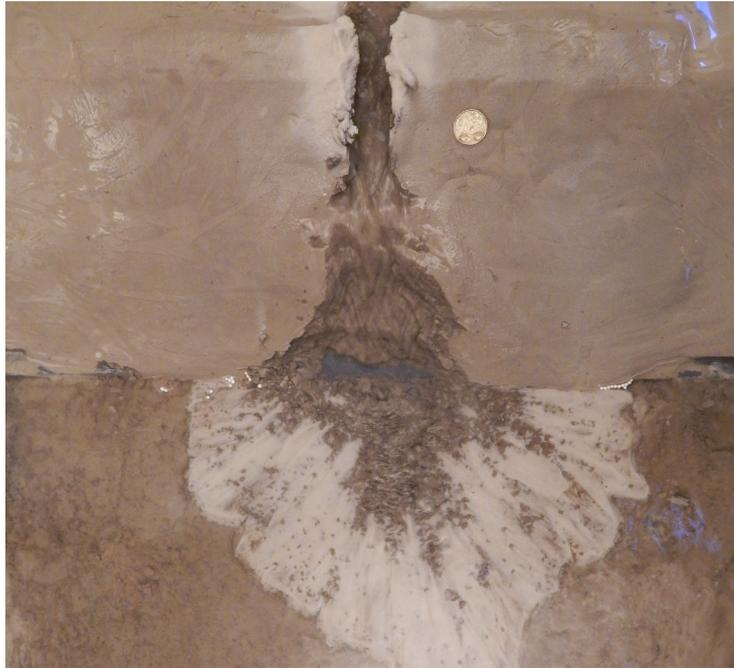
**Figure 141** – On peut constater la lente remontée de l'érosion vers la crête, après 6h30 d'essai. Le dépôt formé au droit de la brèche permet de se figurer les vitesses maximales atteintes en fonction de la distance au pied de digue.
