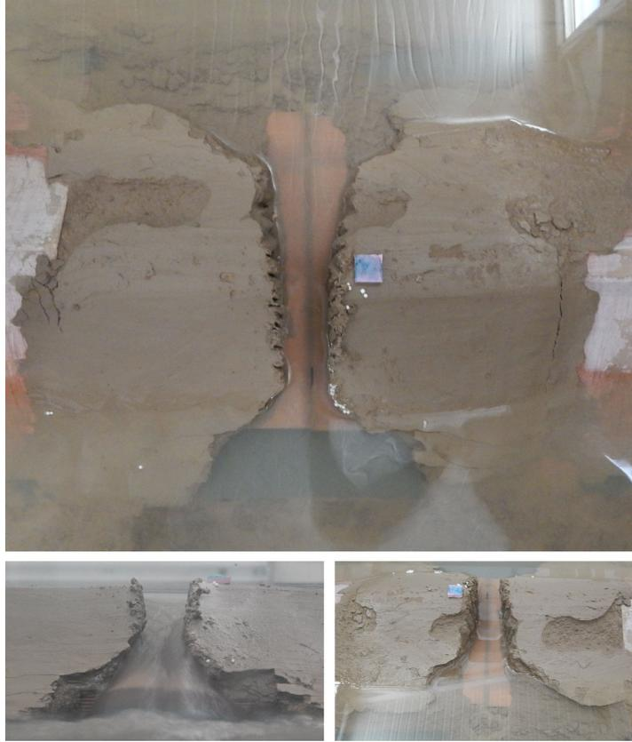
**Figure 125** – Vues de la digue à  $t_s = 38$  h. La largeur de la brèche n'a pas évolué en dépit du courant amont. On constate que les parois de la brèche sont restées verticales et que le parement côté rivière (sur la dernière photo) a été sérieusement endommagé sous l'effet du courant longitudinal.
