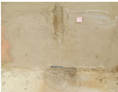
**Figure 134** – Vue supérieure de la digue à  $t_s = 20$  min et début d'érosion en pied, côté ZP.
