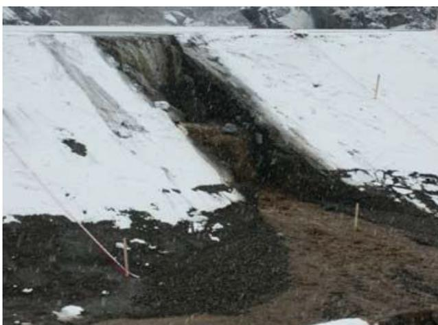
Figure 28 – Formation d'un headcut sur une digue en gravier (projet IMPACT).
