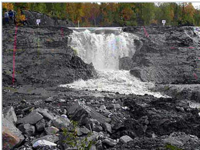
Figure 27 – Phase d'initiation observée sur une digue cohésive (projet IMPACT).
