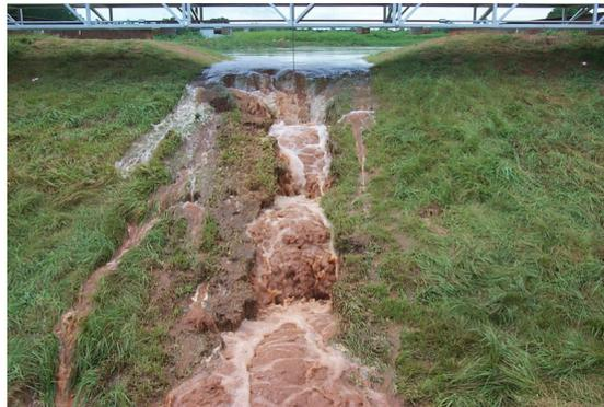
Figure 31 – Phase d'initiation par formation de cavités et de chutes sur le parement aval d'une digue cohésive (Hanson et al., 2005a).
