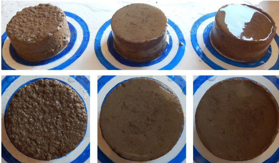
Figure 107 – Vue des échantillons à  $t = 5$  min ( $w = 12, 16, 20 \%$ , 50 % d'argile).
