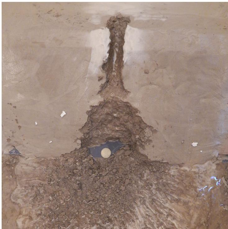
**Figure 142** – Vue de la digue à  $t_s = 10h30$ . L'évolution du chenal d'érosion a ralenti puis s'est stabilisée.
