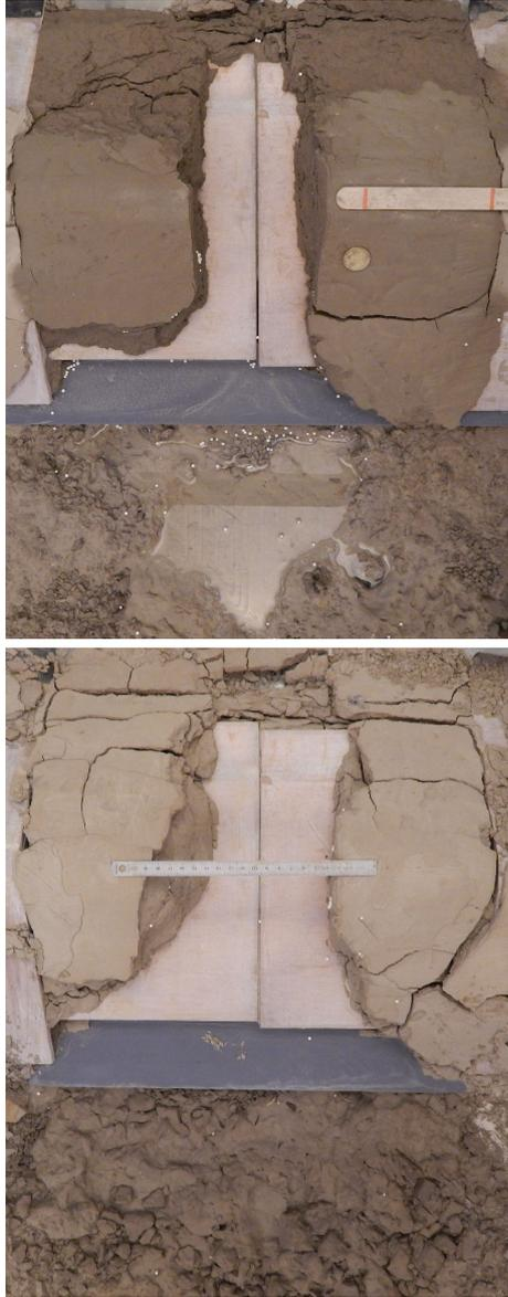
**Figure 153** – Etat des digues K50S50w14 (en haut) et K50S50w18 (en bas) cinq jours après l'arrêt de l'essai. Les fissures parcourent l'ensemble du corps de digue dans le second cas.
