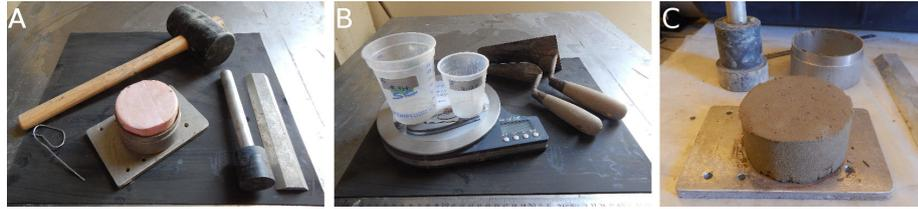
**Figure 89** – Matériel nécessaire à nos essais de compaction (A et B), et échantillon prêt à être mis à l'étuve (C).
