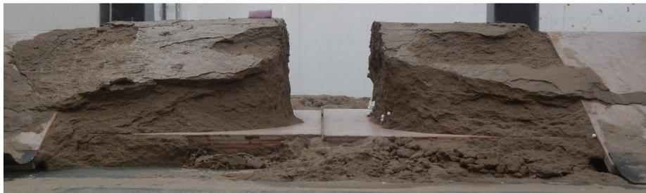
**Figure 131** – Côté rivière, le corps de digue a été substantiellement érodé dès la mise en route du courant amont et plus fortement durant la dernière phase de cet essai.
