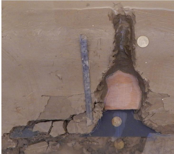
**Figure 149** – Première défaillance de masse en pied de digue à  $t_s = 120$  h
