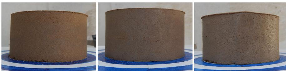
**Figure 101** – Aspect initial des trois échantillons (80 mm de diamètre pour 40 mm de haut à  $w = 11, 14, 17\%$ , 30 % d’argile).
