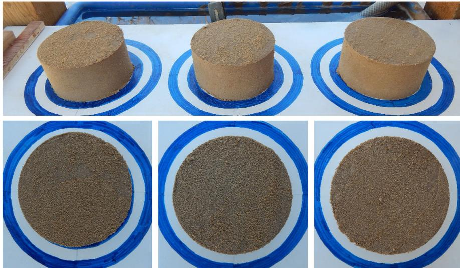
Figure 114 – Vue des échantillons à  $t = 0$  min ( $w = 11, 14, 17\%$ ,  $10\%$  d'argile).
