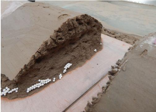
Figure 129 – Détail de la paroi aval de la brèche. Une déflexion d'environ 10 mm sous la ligne d'eau dans le canal d'érosion semble être le seul effet du débit latéral sur les parois.
