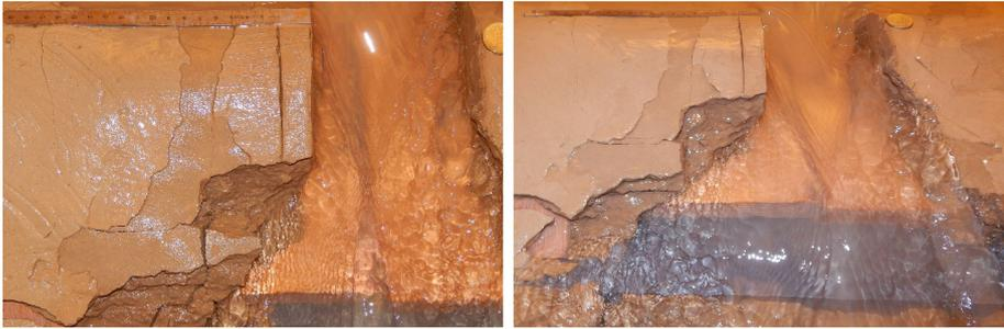
**Figure 151** – Mobilisation d'un bloc sur toute la hauteur de la digue, mais pas jusqu'au pied côté rivière (ce qui est différent des défaillances de masse 'classiques' observées jusqu'alors), puis régularisation de la pente du parement aval ( $t_s \sim 270$  h).
