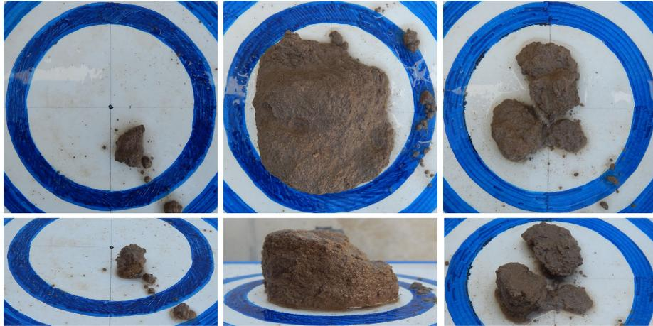
Figure 105 – Echantillons vus de dessus et de côté à  $t = 210$  min ( $w = 11, 14, 17 \%, 30 \%$  d'argile).
