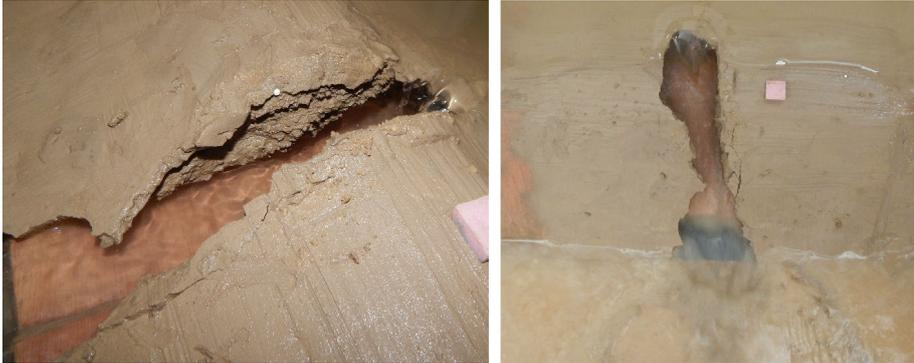
**Figure 138** – Le bas des parois est rapidement érodé, malgré la faible hauteur d'eau dans le chenal d'érosion et certaines parties se retrouvent en surplomb. Un bloc s'effondre en crête, sur la paroi aval, à  $t_s = 44$  min.
