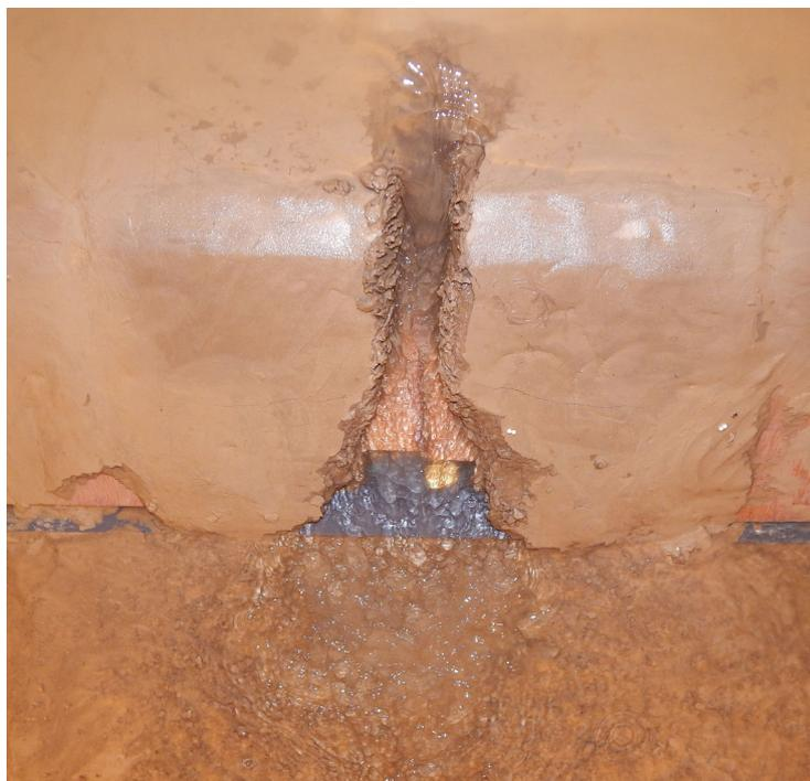
Figure 143 – Plus de 50 h de surverse et des scarifications auront été nécessaires pour obtenir une ouverture du créneau initial sur toute la hauteur, côté ZP.
