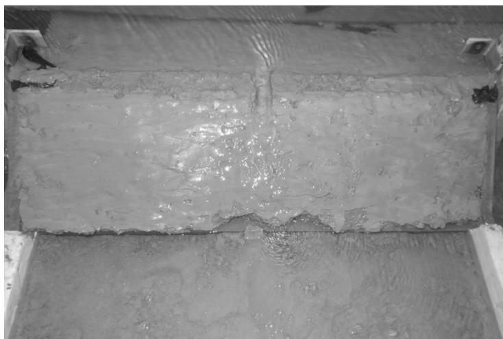
**Figure 51** – Vue de la digue après 4 h de surverse. Le front d'érosion progresse du pied côté zone protégée vers la crête. L'érosion du corps de digue se fait par blocs millimétriques.
