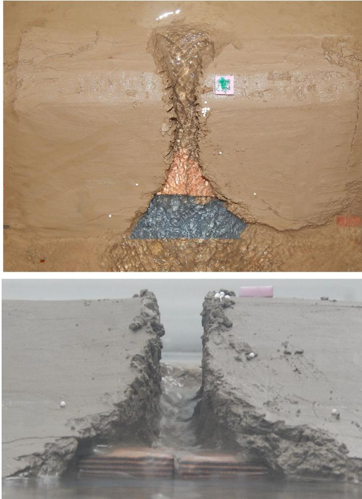
**Figure 124** – Vue de la digue à  $t_s = 23\text{h}10$ . L'érosion a atteint la position de la crête, à une vitesse moyenne de 4,6 mm/h depuis le début de l'essai.
