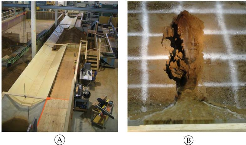
Figure 34 – A : Configuration retenue pour l'étude des digues de canaux dans (Wahl et al., 2011). Le modèle de digue est cohésif et mesure 60 cm de haut ; la défaillance est provoquée par renard. B : Initiation de la brèche ( $t = t_0 + 3$  h). Le débit de fuite dans le conduit provoque la formation d'un headcut.
