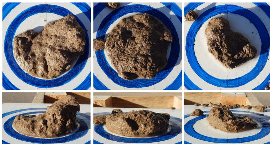
Figure 112 – Vue des échantillons à  $t = 300 \text{ min}$  ( $w = 12, 16, 20 \%$ , 50 % d'argile).
