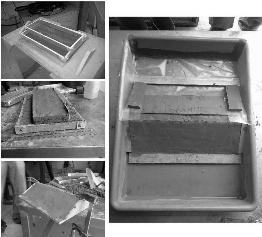
Figure 48 – Etapes de la construction du premier modèle de digue.
