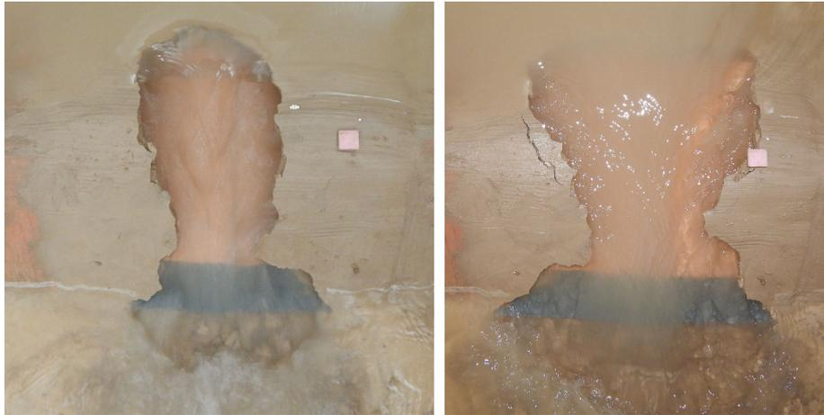
**Figure 140** – La brèche passe de sa largeur initiale (35 mm) à une largeur de 200 mm en moins de 15 min. L'ouverture se fait de manière symétrique.
