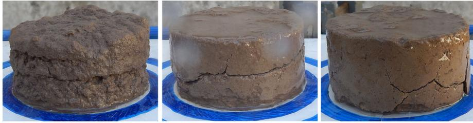
Figure 108 – Vue des échantillons à  $t = 40 \text{ min}$  ( $w = 12, 16, 20 \%$ , 50 % d'argile).
