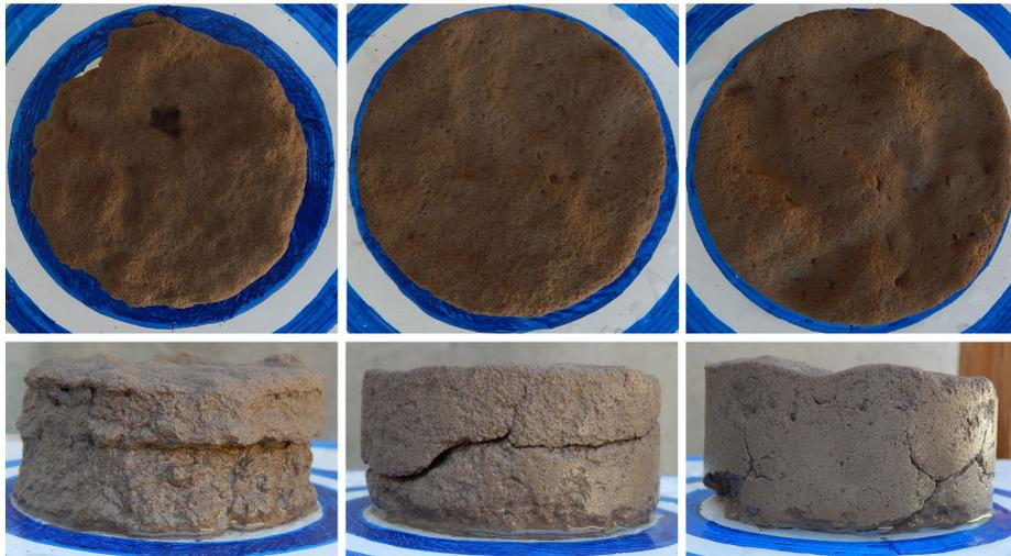
Figure 109 – Vue des échantillons à  $t = 140 \text{ min}$  ( $w = 12, 16, 20 \%$ , 50 % d'argile).
