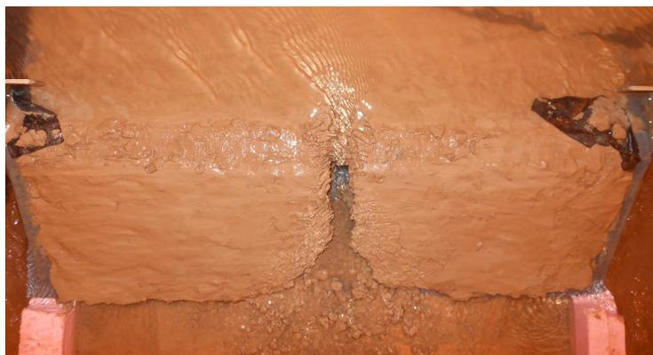
**Figure 54** – Vue de la digue après 9 h de surverse. L'érosion verticale de l'entrée de la brèche débute et le débit de fuite commence à endommager la paroi aval, provoquant un élargissement rapide de la brèche.
