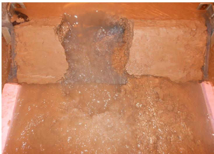
Figure 56 – Vue de la digue après 10h30 de surverse. L'élargissement amorce un certain ralentissement alors que le débit de fuite est de moins en moins orienté dans le sens du courant amont. Notons le ressaut établi au droit de la brèche, indicateur de la dangerosité potentielle de tels phénomènes mis à échelle réelle.
