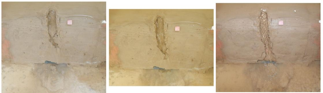
**Figure 136** – Ouverture du chenal d'érosion en quelques minutes, de la crête vers le pied, par détachements successifs de blocs du parement en argile pure.
