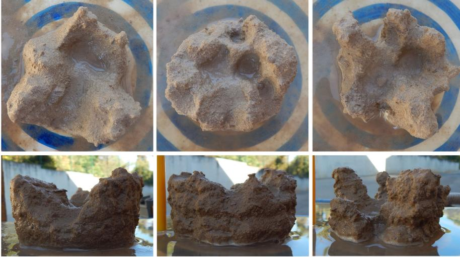
Figure 115 – Vue des échantillons à  $t = 2$  min ( $w = 11, 14, 17 \%$ , 10 % d'argile).
