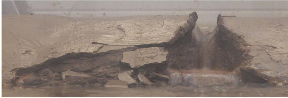
Figure 150 – Poursuite de la défaillance de masse en pied de digue aval à  $t_s = 130$  h
