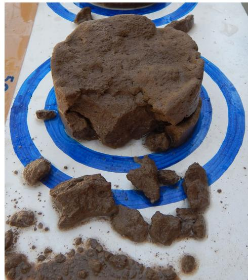
Figure 110 – Détail de l'échantillon à  $w = 20 \%$ , à  $t = 5 \text{ min}$  (50 % d'argile). Mise à jour de plans de rupture.
