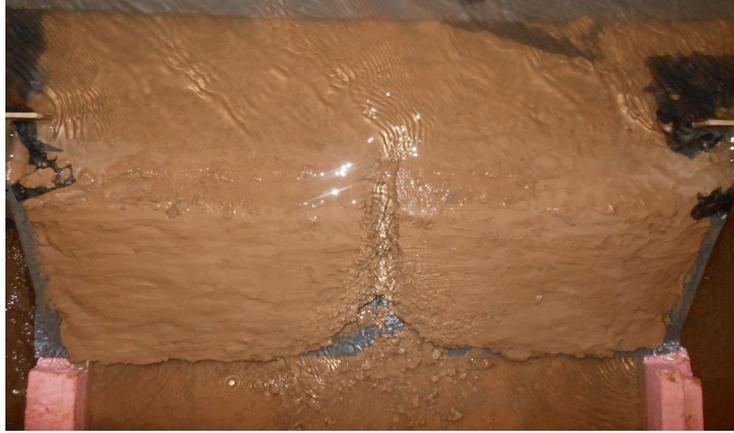
**Figure 52** – Vue de la digue après 8 h de surverse. Le chenal d'érosion s'approfondit peu à peu et l'érosion progresse vers la crête par headcutting, mais la brèche n'a pas évolué sensiblement côté rivière et ses parois restent verticales.
