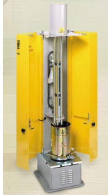
Figure 18 – Dame Proctor automatique permettant de réaliser des essais normaux ou modifiés et de régler le nombre d'impacts par couche. C'est le même genre de machine qui est utilisé à l'Irstea.
