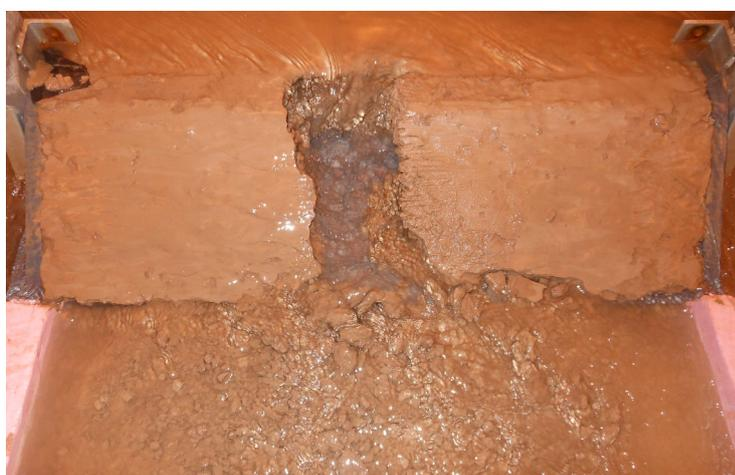
**Figure 55** – Vue de la digue après 9h30 de surverse. Des effondrements soudains de la paroi aval sont provoqués par l'érosion du corps de digue sous la ligne d'eau dans la brèche.
