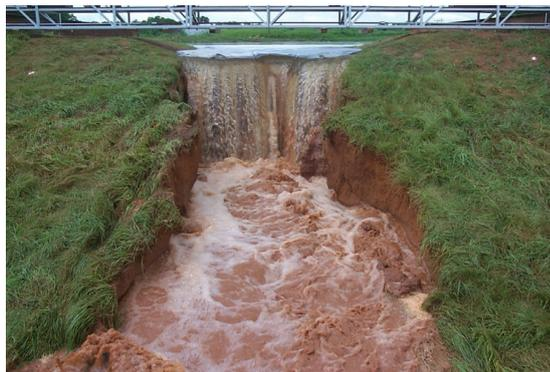
Figure 32 – Formation d'un headcut et érosion régressive vers la crête (Hanson et al., 2005a).
