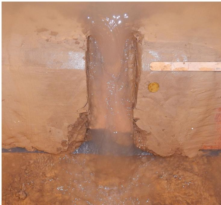
**Figure 145** – Situation de la digue à  $t_s = 150$  h. La géométrie précédente n'a pas évolué durant presque 100 h de surverse, nous avons donc ouvert la brèche sur 100 mm. C'est la position du ressaut créé au droit de la brèche qui semble déterminer l'avancée de la fosse d'érosion. Sur cette photo, le débit longitudinal est nul, et on peut apprécier la belle symétrie du débit sortant.
