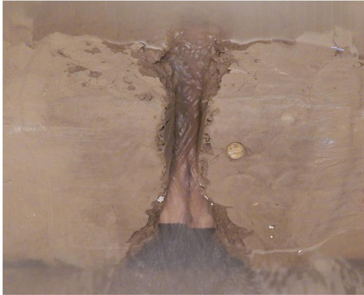
**Figure 144** – A  $t_s = 72$  h, la brèche est ouverte sur toute la hauteur de la digue. Sa géométrie n'évoluera pas durant les 70 h de surverse suivantes.
