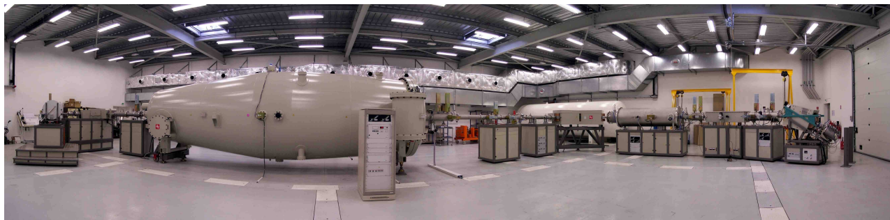
FIGURE 2.7 – Photographie de l'Accélérateur ASTERisque (Accélérateur pour les Sciences de la Terre et les Risques) installé au CEREGE.
