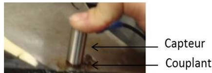
Figure 40 : Exemple de contrôle par contact avec couplant liquide
