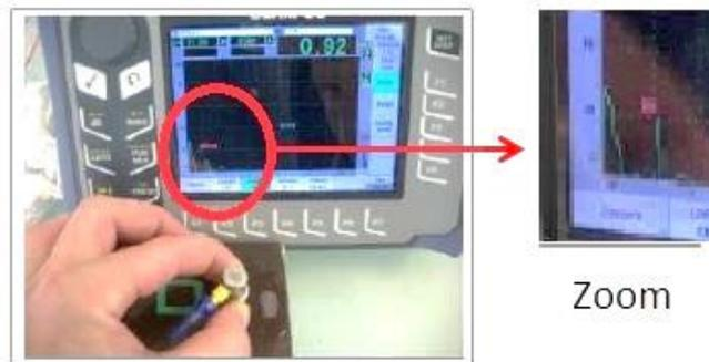
Figure 30 : Contrôle par ultrason réalisé chez Safran Aircelle sur du composite
