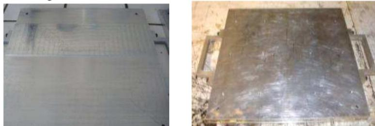
Photo n°5 : Contre moule (à gauche) et moule fermé (à droite)
