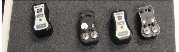
Figure 28 : Différents modèles de sondes pitch catch
