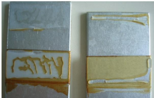
Figure 90 : exemples de faciès de rupture avec la formulation DER 331 et 4% de silice
