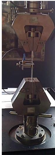
Figure 108 : Dispositif de contrôle par contact lors d'un essai de traction
