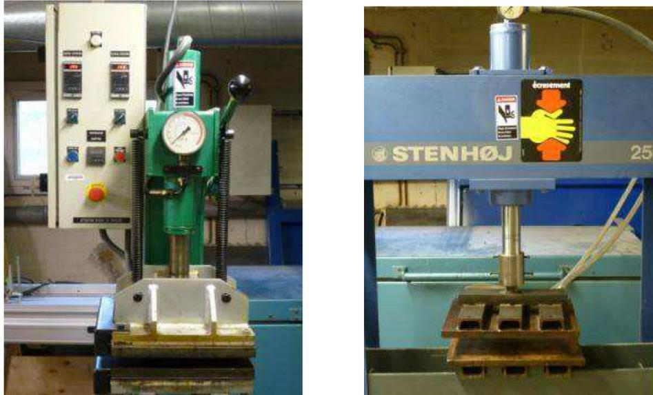
Photos n°6 : Presse à plateaux chauffants (à gauche) et presse froide (à droite)
