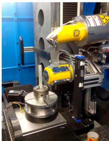
Figure 96 : Enceinte du Tomographe Safran Composite
