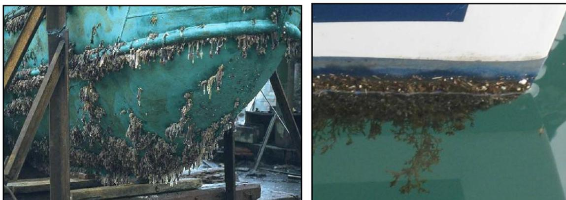
Figure 8. *Biofouling* sur des coques de navire. Le macro-*fouling* est visible, des algues brunes et des moules sont fixées sous la ligne de flottaison (Yebra *et al.*, 2004).
