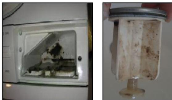
Figure 7. Intérieur d'une machine à laver le linge (à gauche) et un clapet de bonde de lavabo (à droite) recouverts de *biofouling*.
