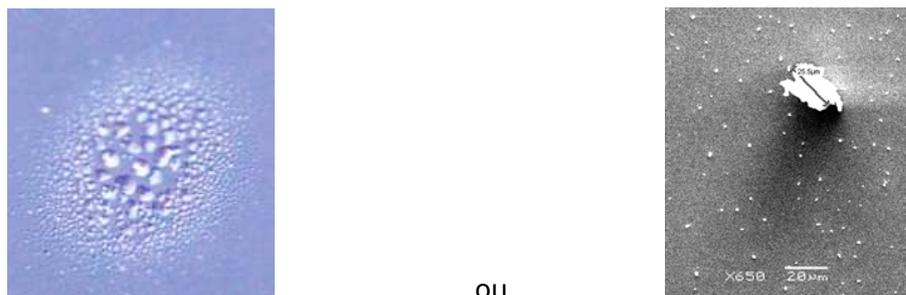
Figure 119 : (a) Auréole de solvant déposé: diamètre 90 µm, (b) Poussière : diamètre 25 µm
