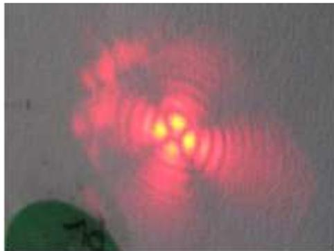
**Figure 56 : Figure de biréfringence induite observée à l'aide d'un faisceau sonde He-Ne dans une lame de Nd:YAG pompée par un faisceau laser à 808 nm de 2W de diamètre 150  $\mu\text{m}$**
