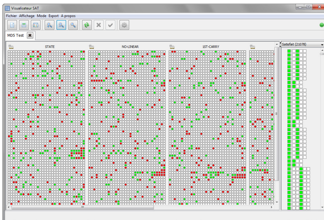
FIGURE V.2 – L’interface de visualisation, pour une formule MD5 quelconque avec quelques variables affectées à vraies (en vert) et à faux (en rouge).
