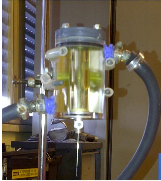
Figura 26. Sistema de filtración isotérmica a presión atmosférica.
