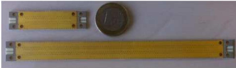
Figure IV-1 : Exemple d'un kit nu d'une ligne triplaque à air sur substrat épais
