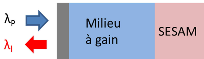
Figure 7. Schéma de principe d'un microlaser déclenché passivement par un SESAM, \lambda_p et \lambda_l sont respectivement la longueur d'onde de pompe et la longueur d'onde laser
