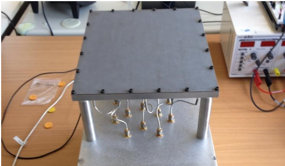
Figure V-16: Prototype final de la matrice antenne fabriquée en présence de la FSS.
