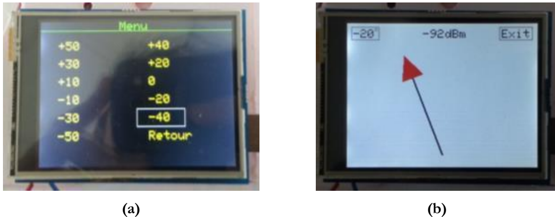
Figure IV-19: Affichage (a) des directions de pointages pour le menu mesure (b) de la direction à suivre et du niveau de signal reçu pour le menu 'Tracking'.
