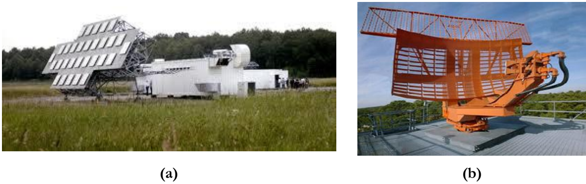
Figure I-8: (a) Radar Grave français conçu pour détecter les satellites orbitant entre 400 et 1000 km (b) Radar primaire à balayage mécanique typique d'un aéroport.
