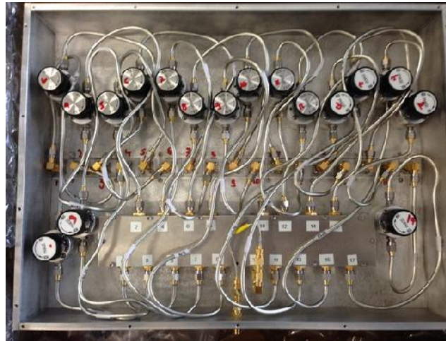
Figure III-34: Le nouveau BFN de MARPEM en présence du diviseur non équi-pondéré.
