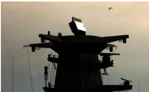
Figure 7: Le radar KRONOS installé sur un bateau militaire.
