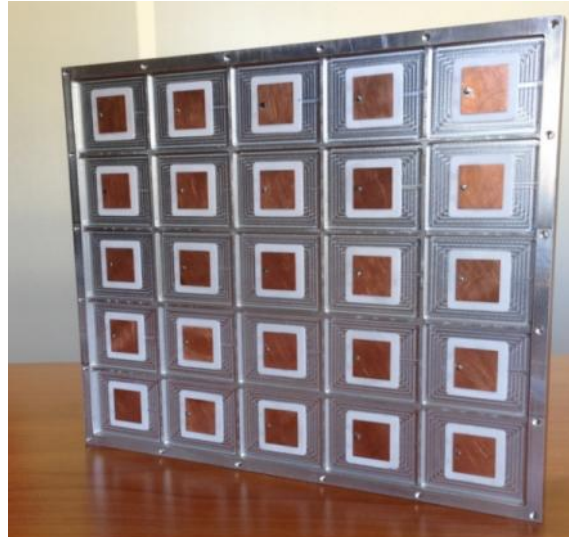
Figure V-15: Matrice antenne fabriquée en absence de la FSS globale.
