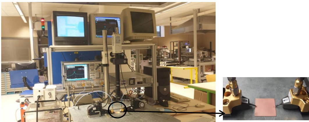
Figure IV-13: Banc de mesure des résonateurs
