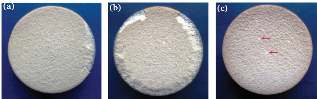
**Figura 5.21.** Falla en la superficie del recubrimiento de (a) CSZ<sub>L</sub> después del choque térmico N° 116 y (b) 400; (c) Recubrimiento CSZ<sub>H</sub> después del choque térmico N° 400
