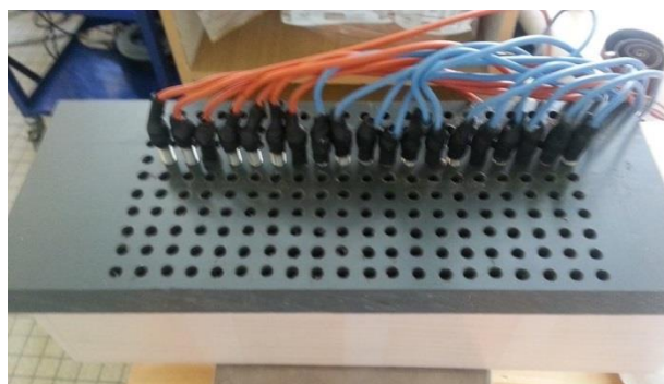
Figure III. 13 : Echantillon de dimensions 320 x 95 x 95 mm 3 équipé de 19 électrodes
