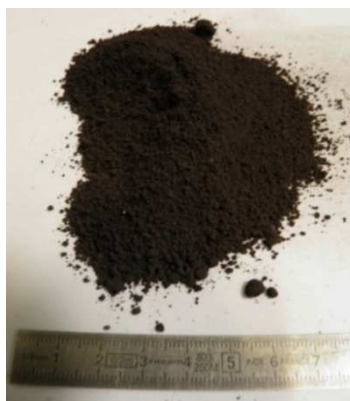
Figure 28 : Sciure de silicium (I1-0) après séchage
