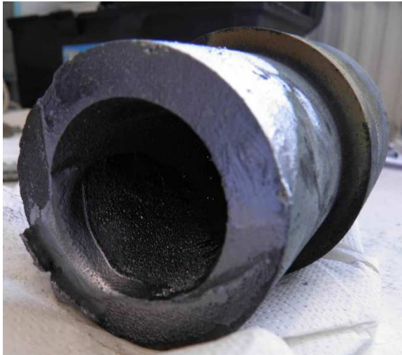
Figure 170 : Résidus issus du film ruisselant de silicium sur les parois internes du prolongateur
