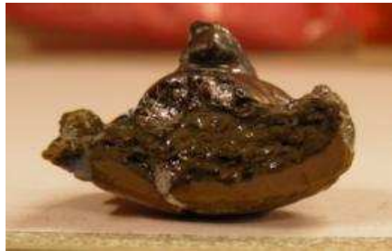
Figure 162 : Pépite de silicium après traitement plasma pendant 5 minutes (7,8 g)
