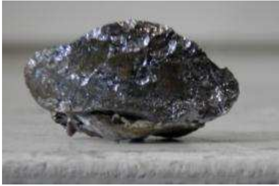
Figure 163 : Pépite de silicium après traitement de 10 minutes (5,9 g) en plasma
