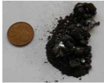
Figure 164 : Pépite de silicium après chauffage de 30 minutes à 1450°C dans un four (10,5 g)
