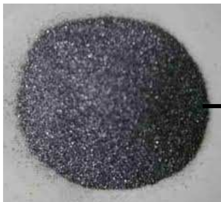
Figure 165 : Poudre de silicium avant traitement plasma (FE1-0)
