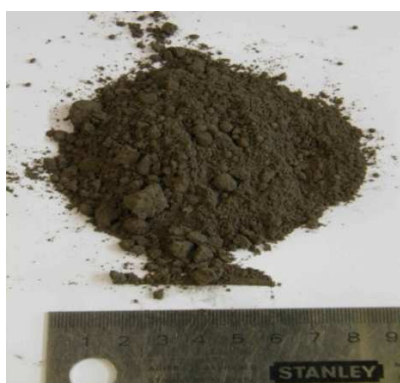
Figure 30 : Sciure de silicium issue de la découpe slurry en vrac (RH3-0)
