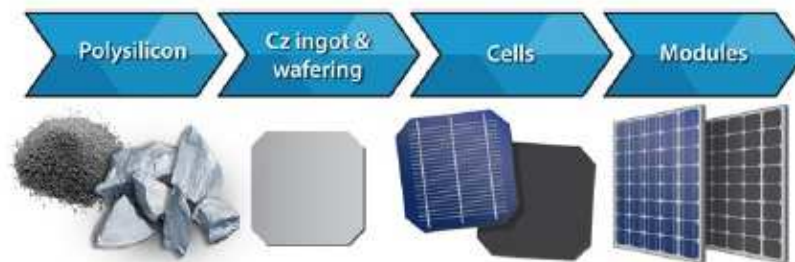
Figure 9 : Du silicium au module photovoltaïque
