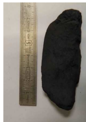
Figure 29 : Sciure de silicium compactée (SiP3-0)
