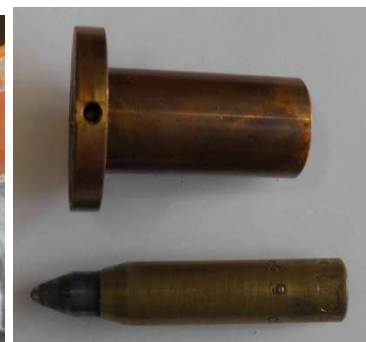
Figure 69 : Jeu d'électrodes : l'anode en haut et la cathode en bas
