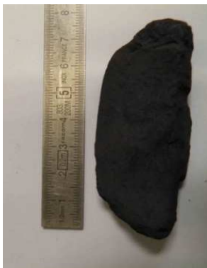
Figure 161 : Sciure de silicium compactée avant traitement (SiP3-0)
