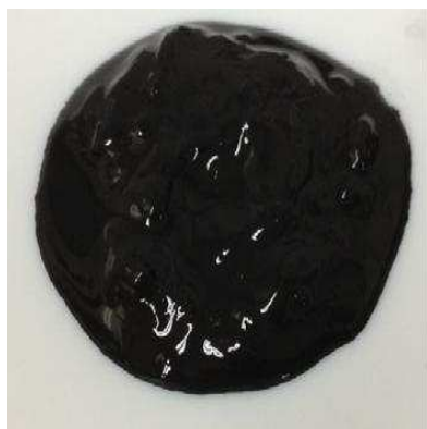
Figure 27 : Sciure de silicium issue de la découpe diamant avant séchage
