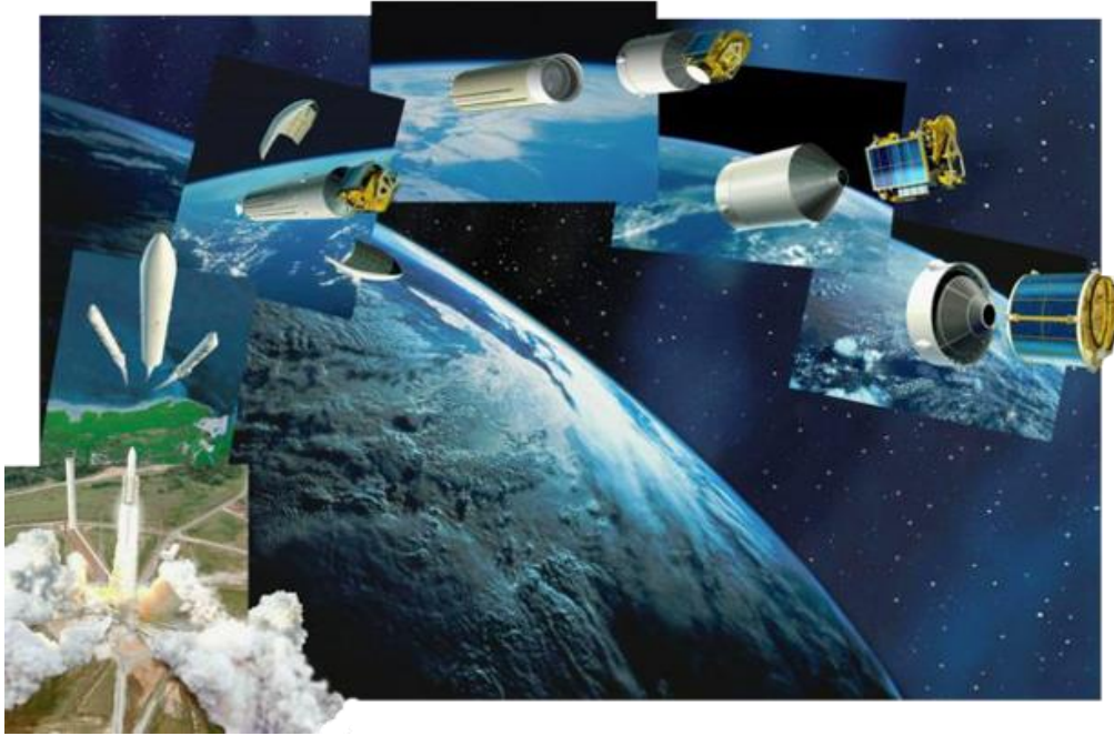
Figure I.8. Cycle de vol du lanceur ARIANE 5
