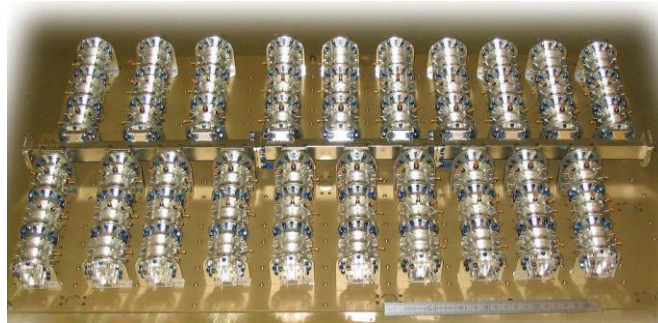
Figure I.10. Filtre d'OMUX à 20 canaux
