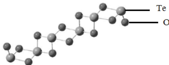
Figure II.5 : Structure en chaîne d'un cluster (\text{TeO}_2)_n [6].
